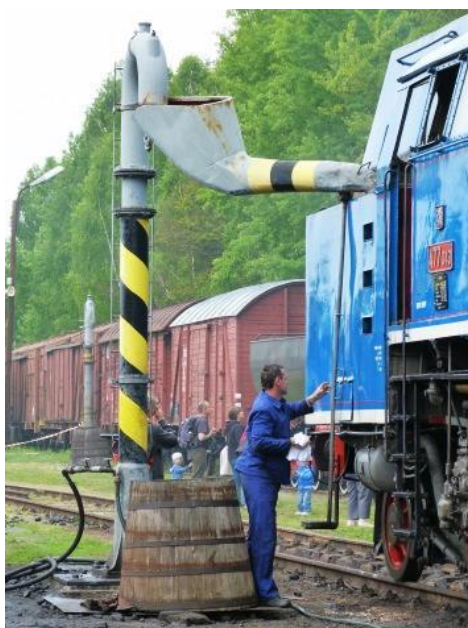
Obr. 6 Zbrojení parní lokomotivy vodou
