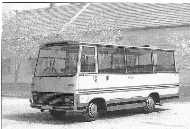
Obrázek 3 - Karosa A 30; prototyp na podvozku Saviem (4)
