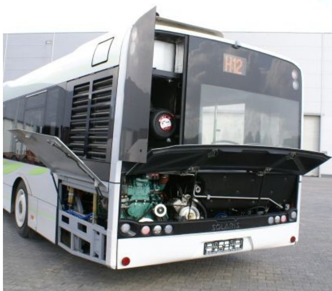
Obrázek 29 - Solaris Urbino Hybrid; umístění komponentů (45)
