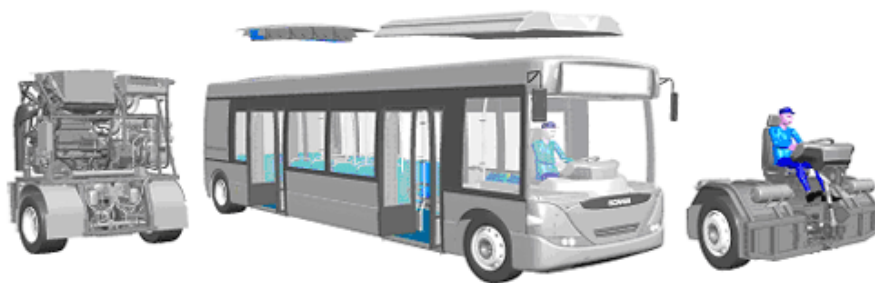
Obrázek 17 - Koncept Scania Hybrid; rozmístění komponentů (26)
