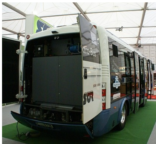
Obrázek 21 - SOR ENB 8 Elektrobus na BusWorld 2013; umístění baterií (32)
