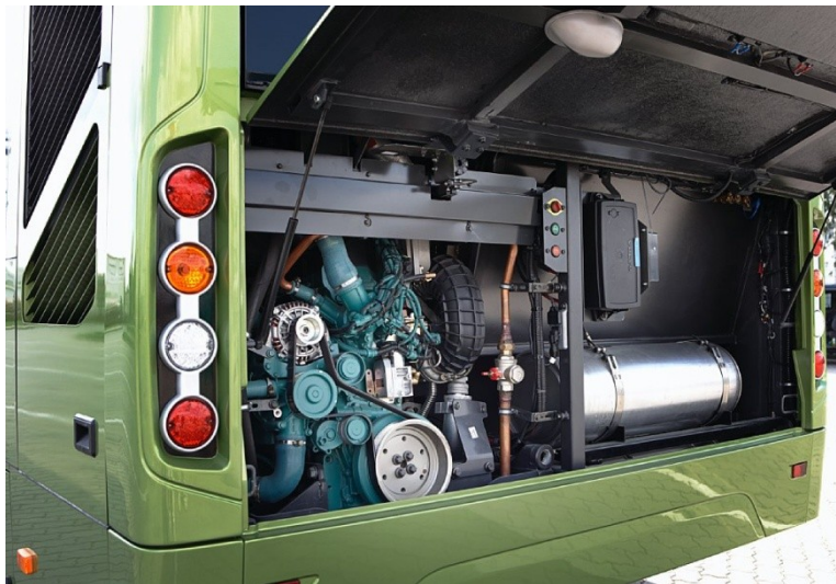
Obrázek 13 - Volvo 7900 Hybrid; umístění komponentů pohonu (19)
