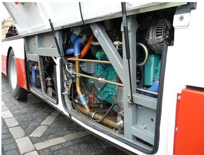
Obrázek 20 - SOR HNB 18 Hybrid pro DP Praha; umístění komponentů (31)
