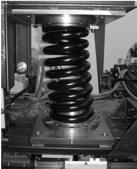
Obr. 4 Prvky vypružení a vedení dvojkolí při zkoušení
