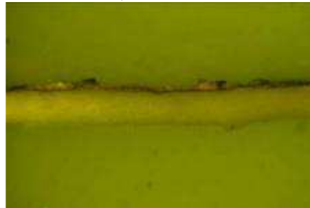
REM-BEI, detail podkladové vrstvy s viditelnými zbytky mikrofosílií
