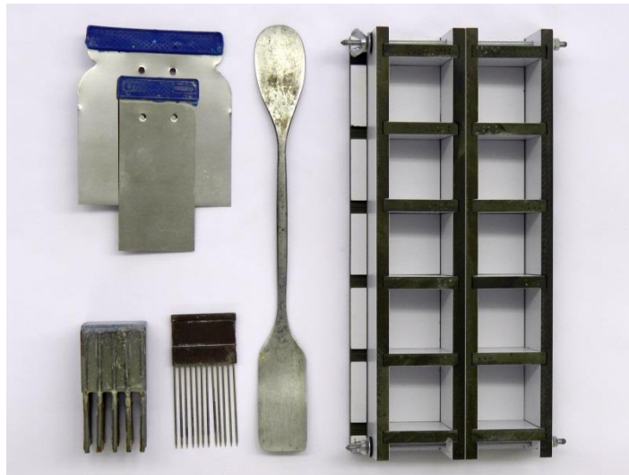
Obr. 52: Nástroje a forma ke zhotovení laboratorních zkušebních tělísek
