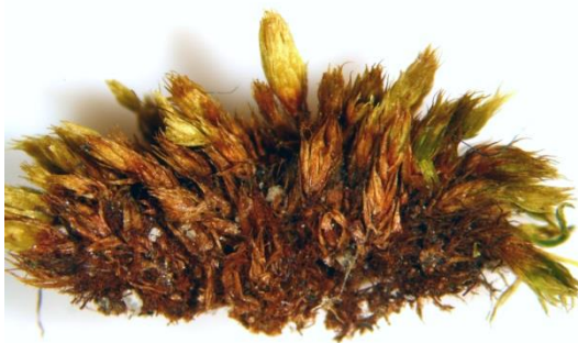
Obr. 38: Mech pevně vrůstající do struktury kamene v příčném řezu Optický mikroskop; fotografováno v dopadajícím světle při zvětšení 12,5×
