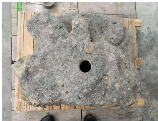
Obr. 86: Referenční zkušební plocha po částečném očištění, připravena na testování konsolidantů
