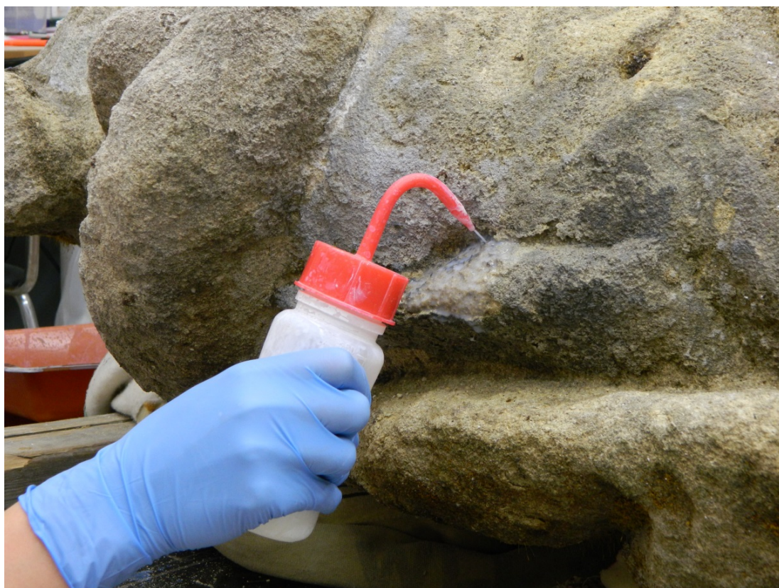
Obr. 130: Průběh konsolidace fragmentu trupu vápennou nanosuspenzí; detail aplikace pomocí stříčky
