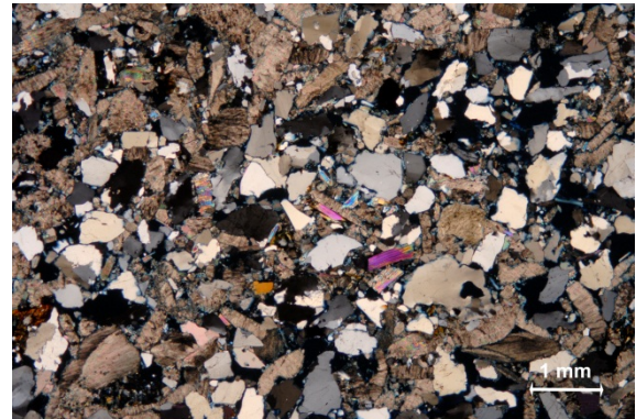
Obr. 43: Výbrus vzorku SR4 (7RKH1) Optický polarizační mikroskop; fotografováno v procházejícím světle v režimu zkřížených nikolů při zvětšení 20×
