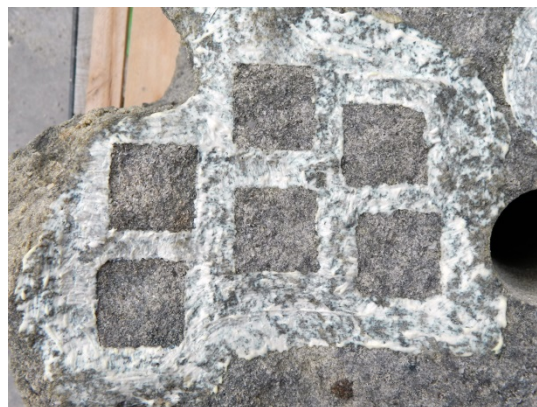
Obr. 88: Vymezené testovací aplikační plochy po odstranění papírových šablon před zaschnutím samovulkanizační pasty
