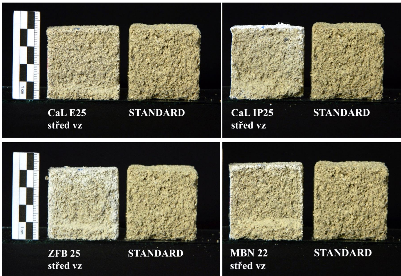
Obr. 75: Lomové plochy středů zkušebních tělísek konsolidovaných vápennými nanosuspensemi o přibližné koncentraci 25 g/l
