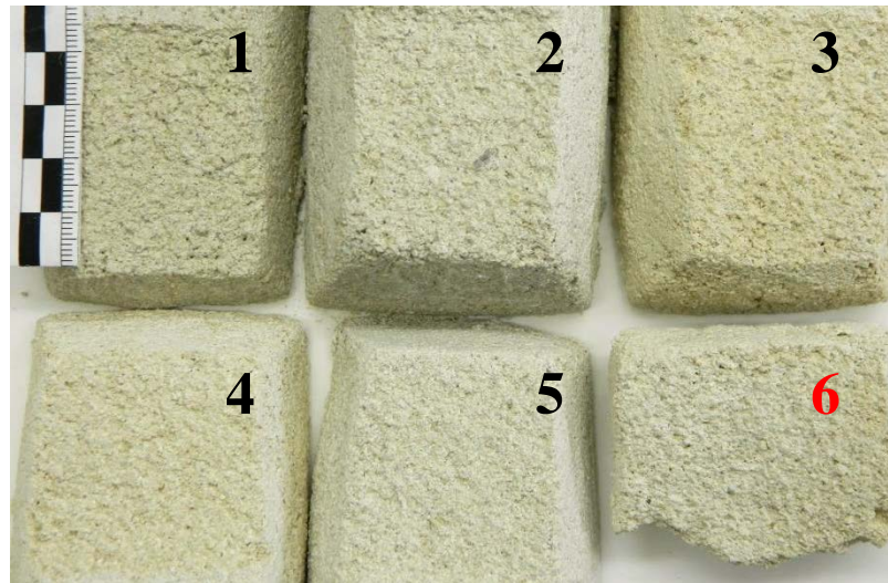
Obr. 100: Zkoušky tmelů; vybraný tmel je na obrázku označen červeně
