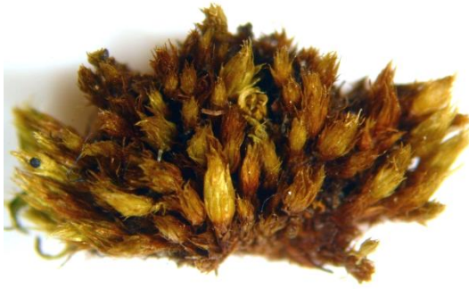
Obr. 36: Mech pevně vrůstající do struktury kamene shora Optický mikroskop; fotografováno v dopadajícím světle při zvětšení 12,5×
