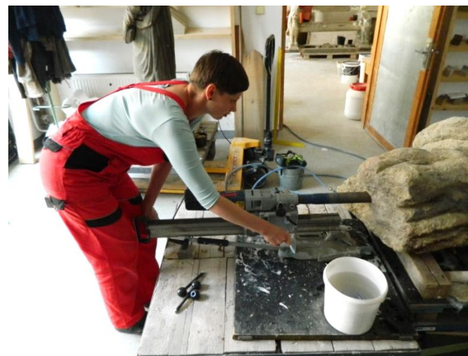
Obr. 140: Vrtání otvoru jádrovým vrtákem do trupu sochy
