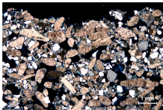
Obr. 60: Výbrus vzorku 7MSLCO x _KH2, povrch Optický polarizační mikroskop; fotografováno v procházejícím světle v režimu zkřížených nikolů při zvětšení 20×
