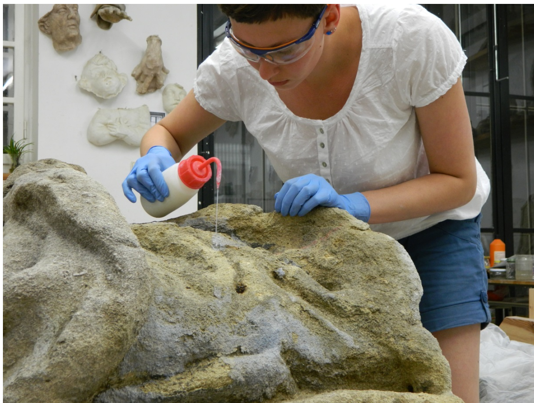
Obr. 129: Průběh konsolidace fragmentu trupu vápennou nanosuspenzí
