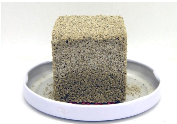
Obr. 71: Příklad pohybu rozpouštědla při jeho odparu – tělísko přibližně 15 h po ošetření prostředkem NR 1P 10
