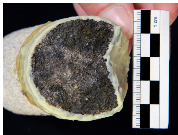
Obr. 84: Detail povrchu vrtného jádra pokrytého biogenním povlakem před očištěním
