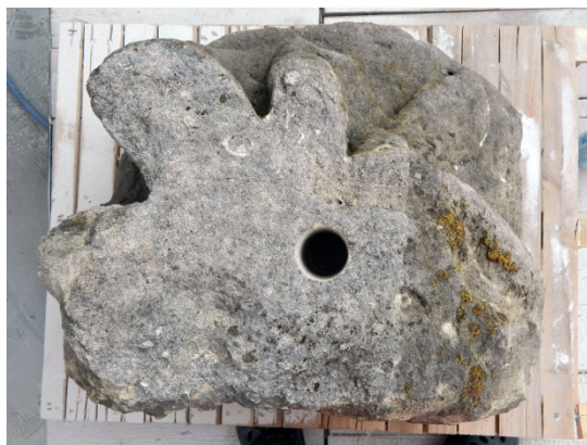
Obr. 85: Referenční zkušební plocha po částečném očištění mikropískováním (vpravo neočištěná část)
