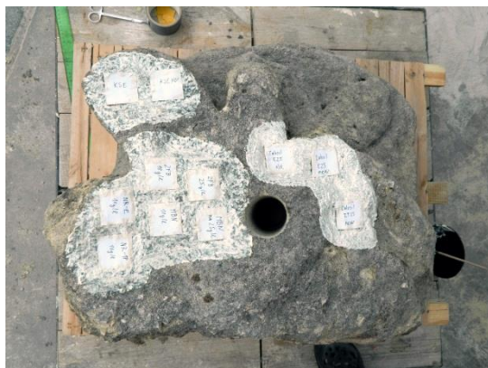
Obr. 87: Vymezení zkušebních ploch papírovými šablonami a natření jejich okolí samovulkanizační pastou
