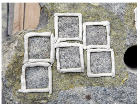
Obr. 89: Samovulkanizační pasta po zaschnutí a dodatečné ohraničení zkušebních aplikačních ploch plastickým tmelem
