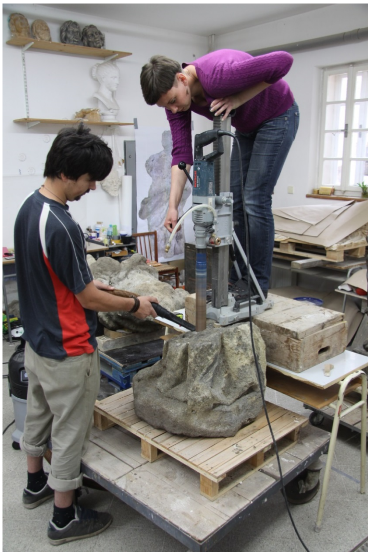
Obr. 135: Vrtání otvoru pro čep jádrovým vrtákem do spodní části sochy – fragmentu nohou s plintem
