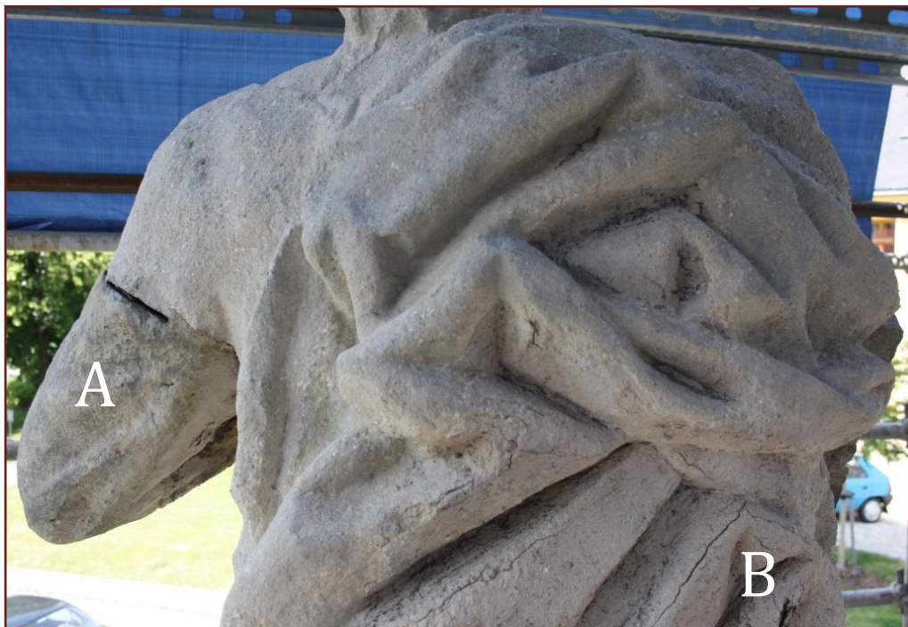
Obrázek 21: A - Pohled po očištění, druhotný doplněk horní končetiny a jeho osazení, B – praskliny.
