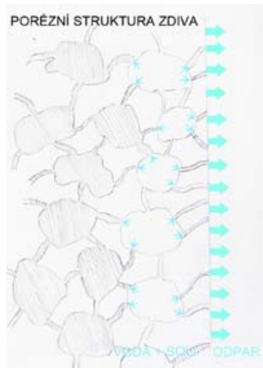
Obr. III: Druhá fáze vysychání - v porézní struktuře materiálu. Začíná u povrchu a pokračuje do hloubky. Vlhkost se stahuje z velkých pórů do malých, kde se nakonec vypaří.
