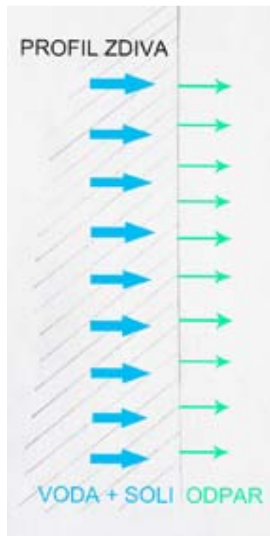
Obr. II: První fáze vysychání - na povrchu, tvorba efflorescence.
