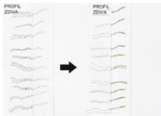
Obr.V: Schématický náčrt kapilárních systémů zdiva a advekčního zábalu. Vpravo po extrakci solí ze zdiva.
