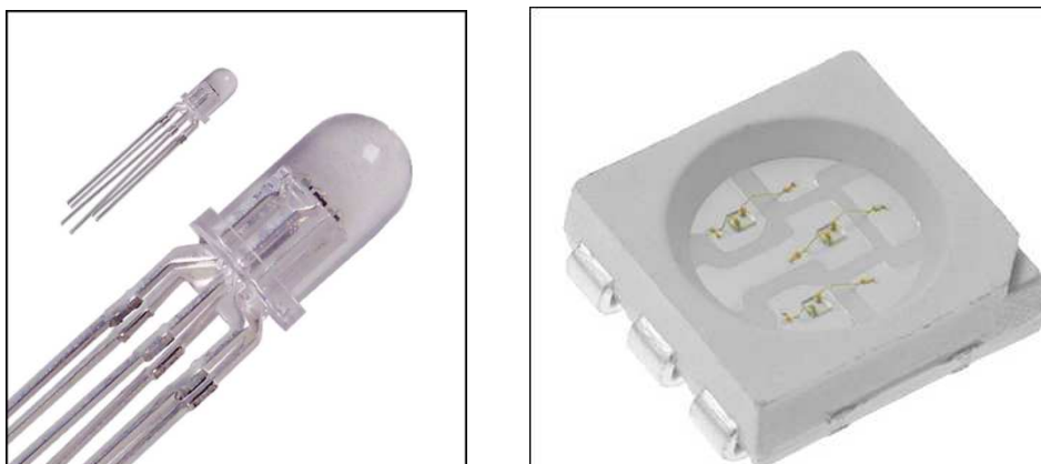
Obrázek 23 - Klasické a SMD provedení RGB diody
