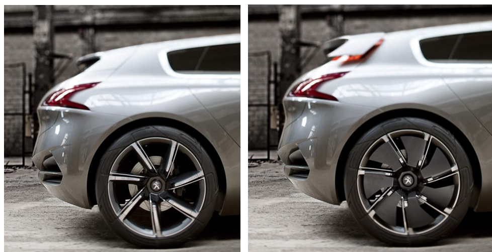
Obr. 16 - Aktivní aerodynamický prvek zádě Peugeotu HX1 koncept [15]
