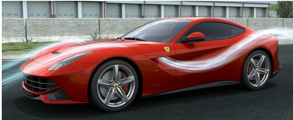
Obr. 14 - Vizualizace proudění vzduchového mostu u modelu Ferrari F12 Berlinetta [13]
