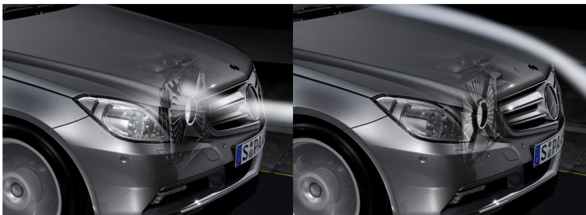
Obr. 11 - Automatické clonění chladiče u vozu E-Class Coupe značky Mercedes [11]
