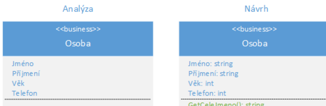
Obr. 2. 2 - Rozdíl mezi konceptuálním a návrhovým modelem diagramu tříd
