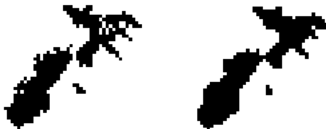
Obrázek 31 – Efekt filtru s Gaussovským rozděleními váhovými koeficienty dle vzorce 3.5, vlevo
