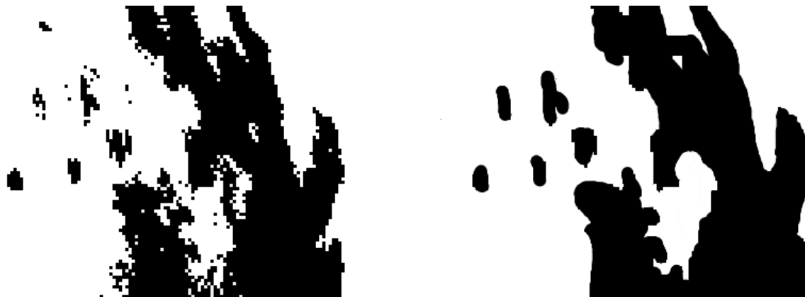
Obrázek 10 – Očekávaný efekt filtru (vlevo situace před filtrací, vpravo po filtraci)
