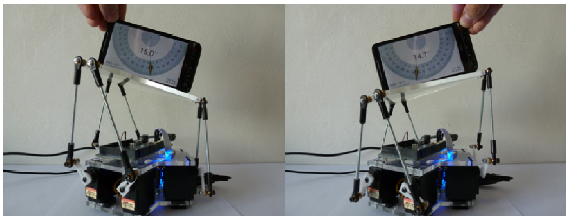
Obrázek 42 – Příklad nastavení rotace okolo osy y , \psi = \pm 15^\circ
