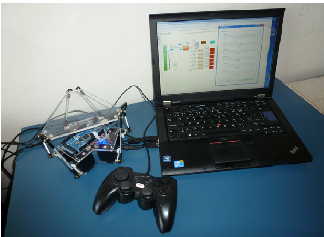
Obrázek 41 – Kompletní systém testovací plošiny pro inerciální navigaci
