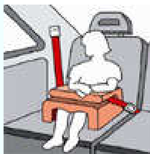
Obr. 8 Zádržné těleso – přes nohy dítěte
