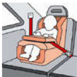
Obr. 5 Systém se záchytným tělesem
