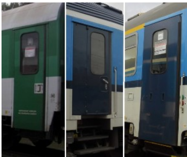
Obr. 2 Předsuvné dveře s madlem (vlevo), dveře s klikkou (uprostřed), předsuvné dveře pneumatické (vpravo)
