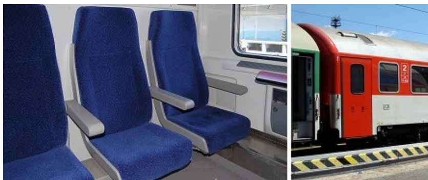
Obr. 9 Interiér a předsuvné pneumatické dveře osobního vozu Bee 240
