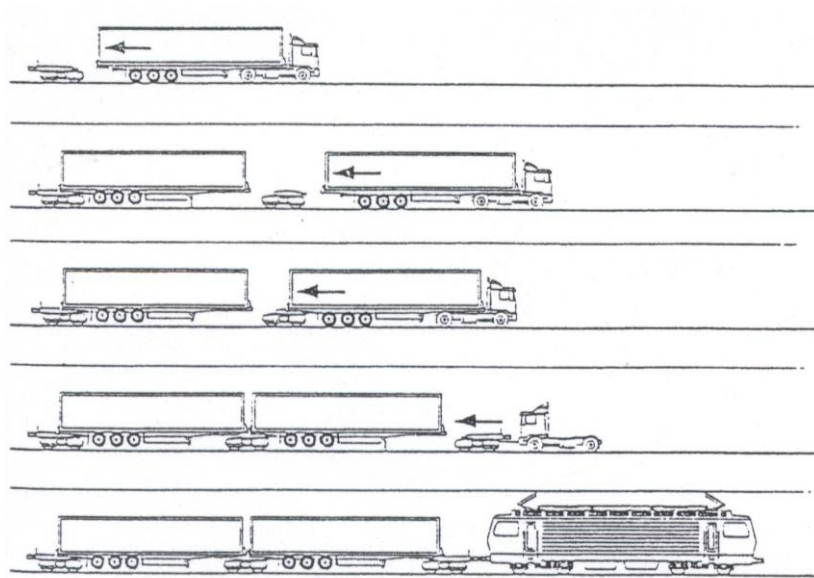
Obrázek 1 Technologický postup při sestavě vlaku z podvojných návěsů
