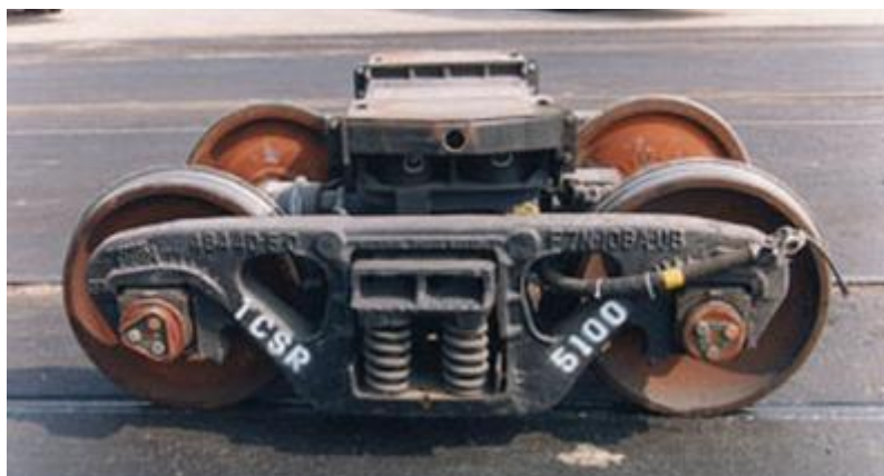
Středový podvozek RoadRailer
