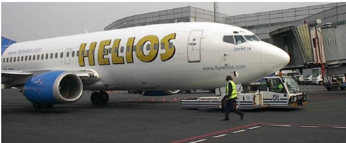
Obrázek 5: RCS doprovází letadlo při pushbacku
