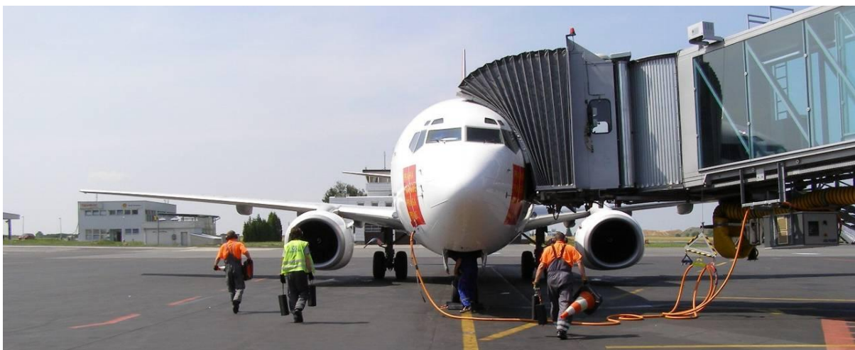
Obrázek 2: Zajištění letadla brzdícími klíny
