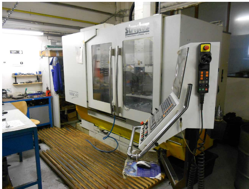
Obr. 10 - Stolová frézka Strojtos
