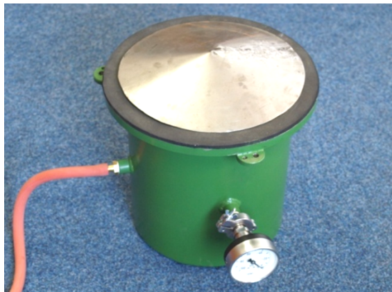
Obr. 4.15 Zkušební zařízení s volně položeným experimentálním modelem
