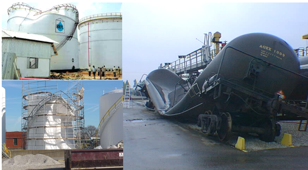
Obr. 2.1 Příklady mezního stavu boulení v praxi
