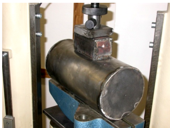
Obr. 4.4 Experimentální model skořepiny uchytený v lisu
