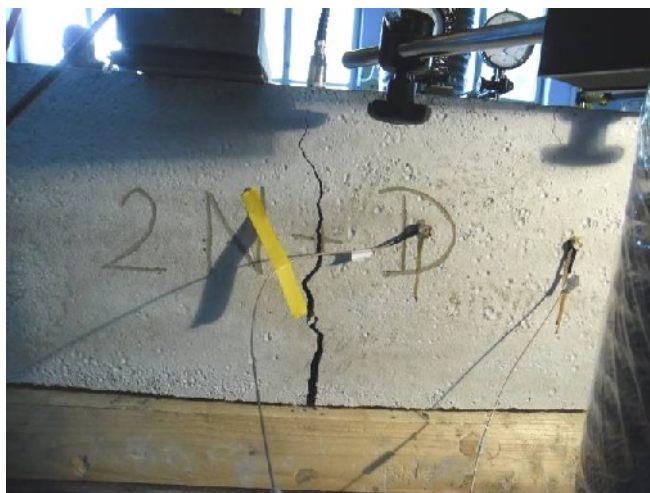
Obr. 114 – Trhlina – trám 2N+D
