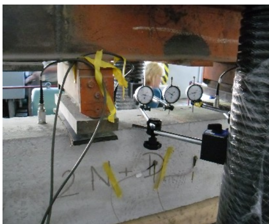
Obr. 108 – Umístění snímacích hodin a čidel
