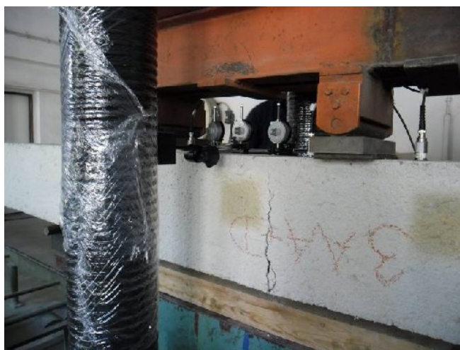
Obr. 110 – Trhлина – trám 3A+D
