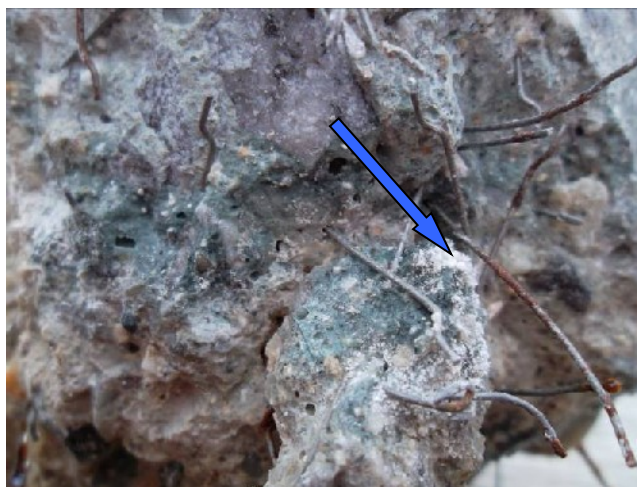
Obr. 146 – Výkvěty na vzorku materiálu po půlroce uložení ve vodní lázni
