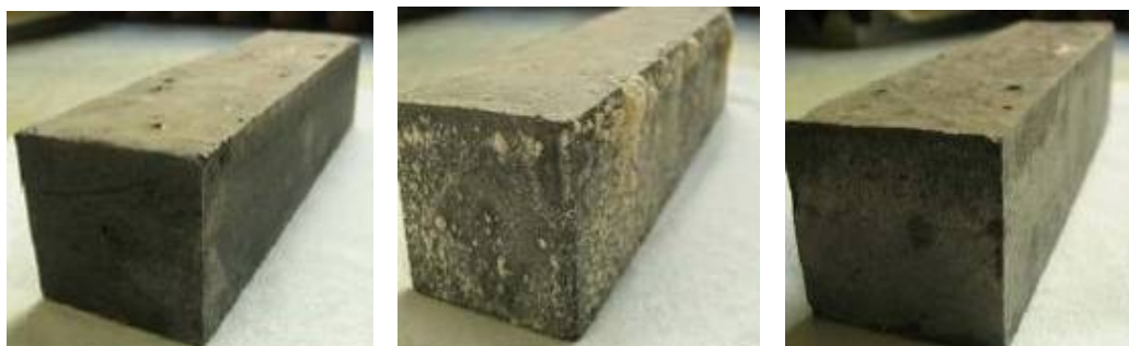
Obr. 23 – Vzhled vzorků po dvouletém působení solných roztoků - vlevo NaCl 16,4 %, uprostřed Na 2 SO 4 4,4 %, v pravo MgSO 4 5 % [3]
