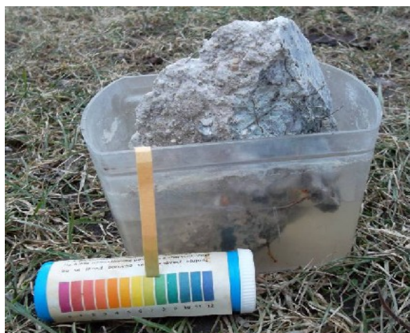
Obr. 147 – Uložení vzorku a měření pH výluhu
