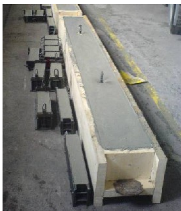
Obr. 76 – Vybetonovaný trám 1N a doprovodné vzorky
