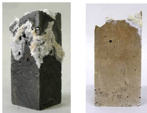
Obr. 25 – Výkvěty na POPbetonu® – vlevo nevypálený vzorek, vpravo vypálený na 600 °C - zřetelná výrazná redukce výkvětů [16]
