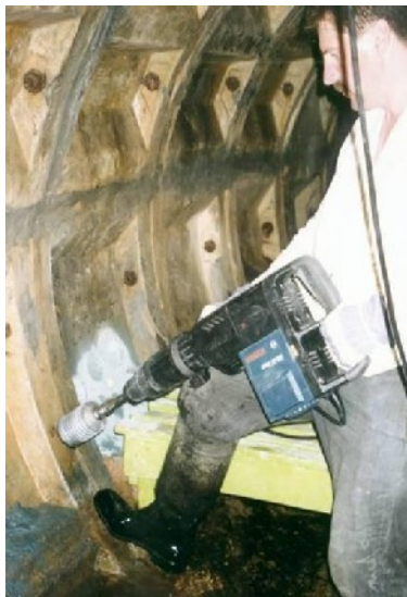
Obr. 37 – Oděsa, Ukrajina (1966) - kolektory pro podzemní vodu z alkalicky aktivovaného struskového betonu (odběr vzorku, pohled zevnitř) – kontrola v roce 2000 [34]
