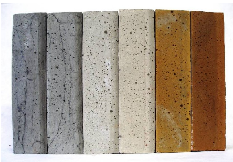
Obr. 30 – Alkalicky aktivované popílkové malty – zleva výpal na 20, 200, 400, 600, 800 a 1 000 °C [5]
