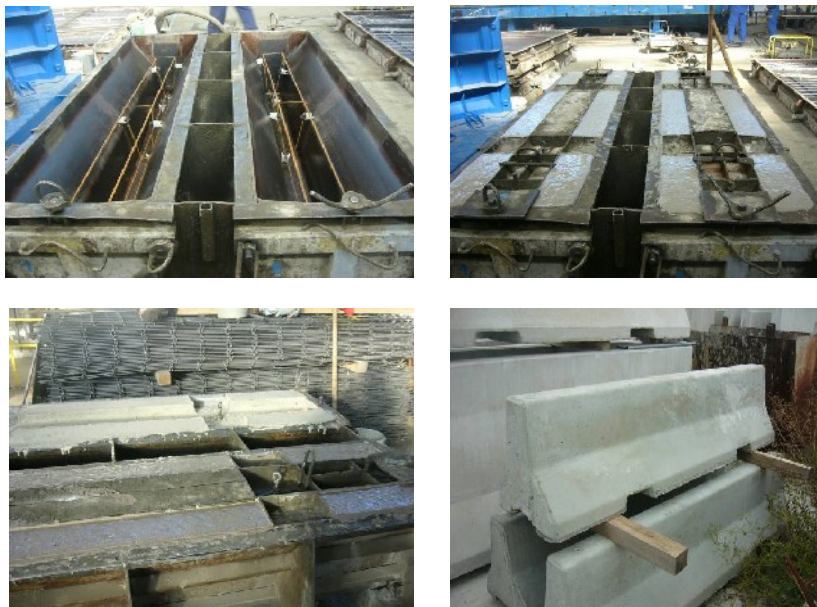
Obr. 48 – ŽPSV a.s. Brno – silniční zábrany z alkalicky aktivovaného struskového betonu (2011) [38]
