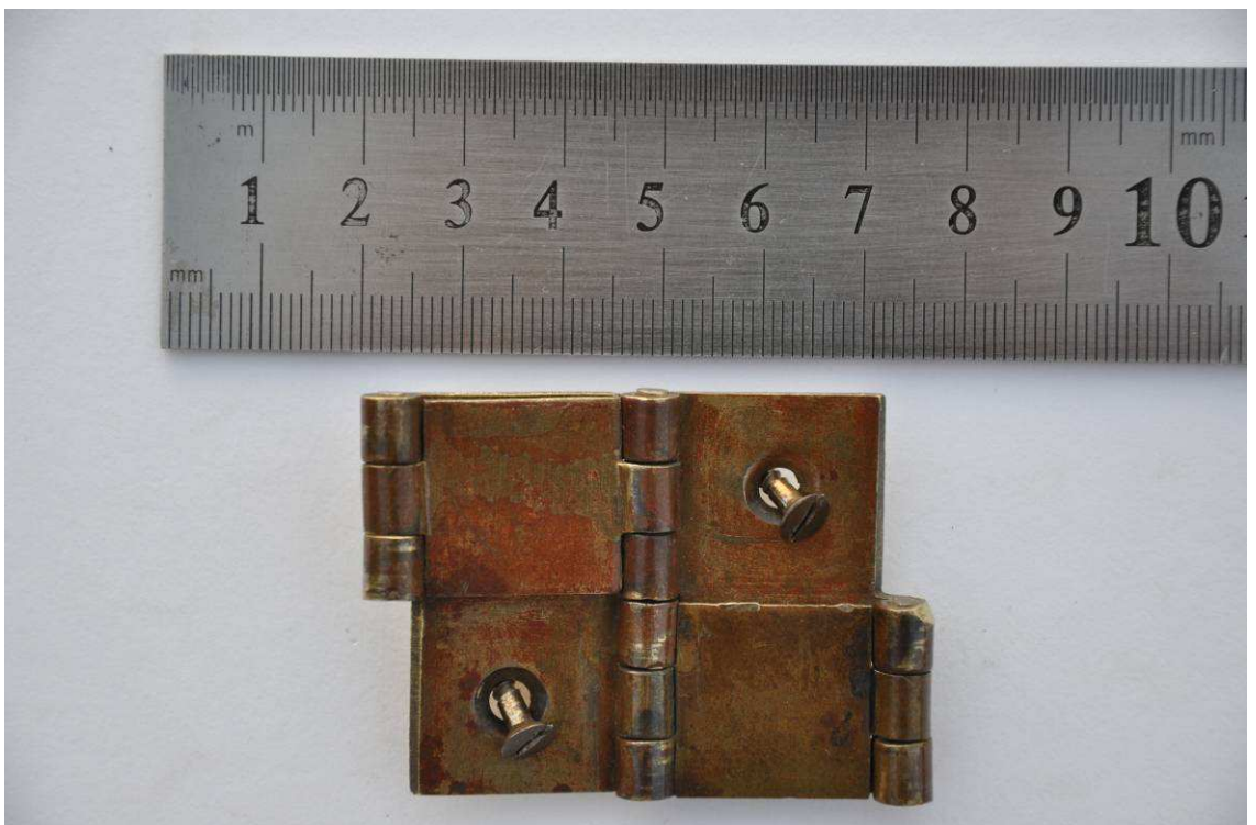
Obr. 88 Demontovaný mosazný pant po restaurování.
