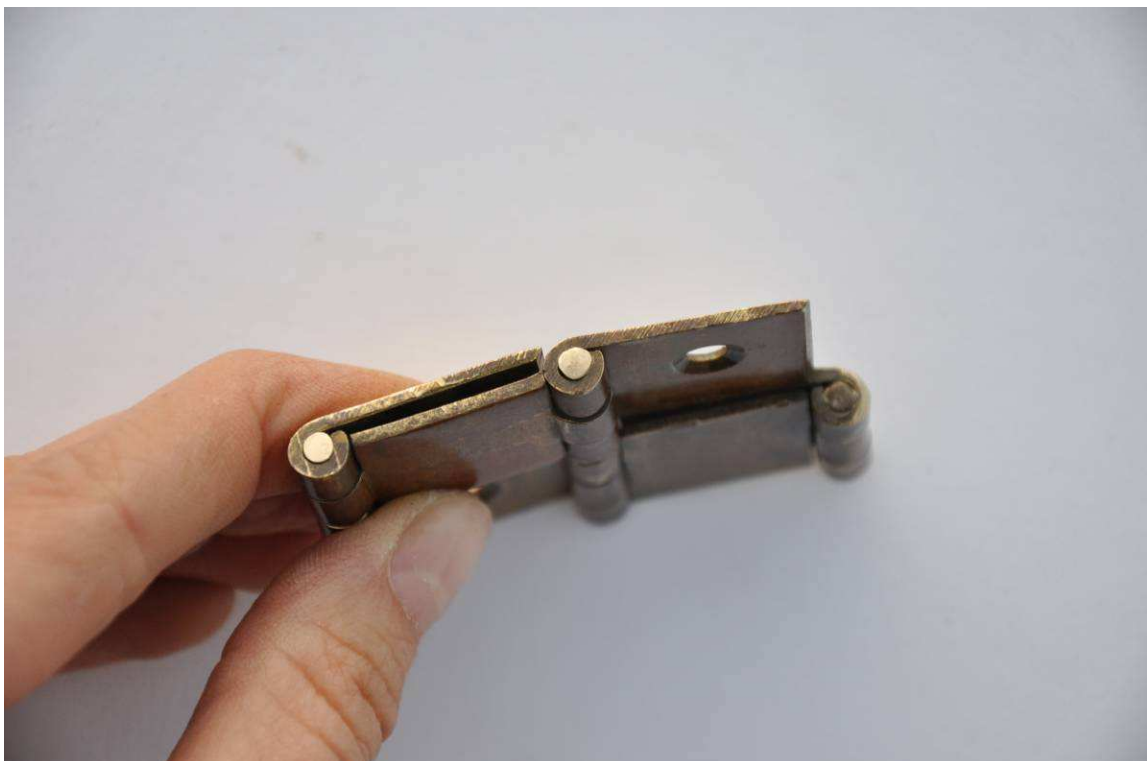
Obr. 86 Průběh restaurování, dosazení nových os v pantu vyrobených z mosazného drátu požadované tloušťky.
