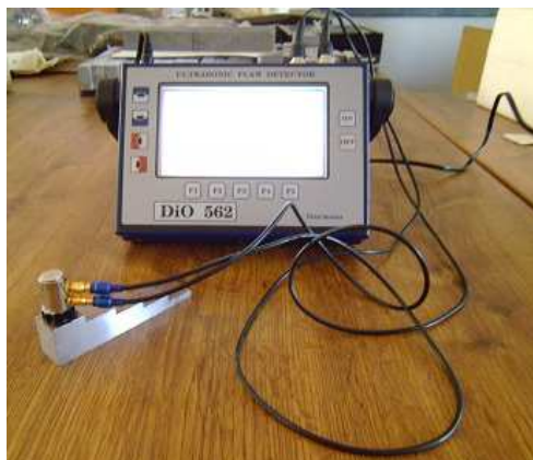
Obr. 4.8 – Ověřování přesnosti měření na stupňové měrce
