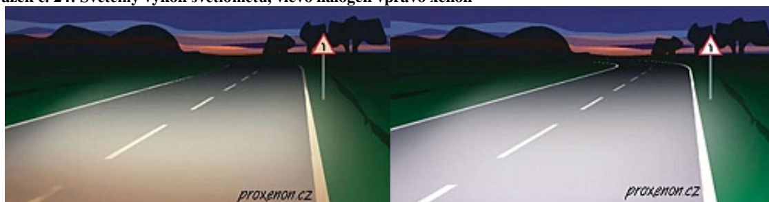
Obrázek č. 24: Světelný výkon světlometů, vlevo halogen vpravo xenon
