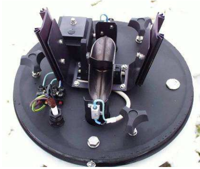
Obr. 8 Vnitřní část srážkoměru SR 49 (ve středu člunkové čidlo) [M. Pančenko]
