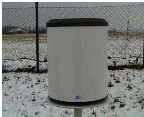
Obr. 7 Srážkoměr SR 49 (pohled ze strany) [M. Pančenko]
