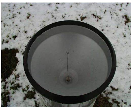
Obr. 6 Automatický srážkoměr SR 49 (pohled shora) [M. Pančenko]
