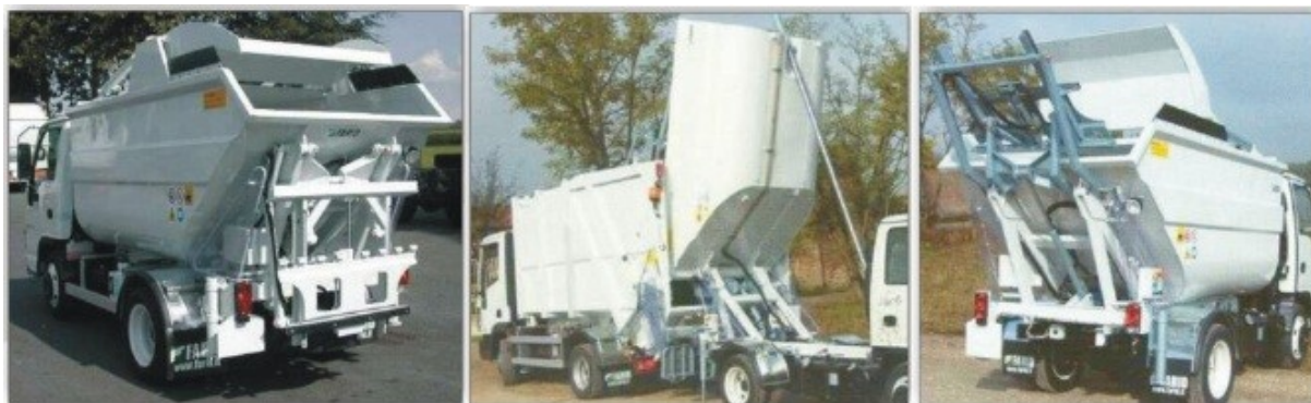
Obrázek č. 19: Funkce nástavby (lisování, překládka do jiného svozového vozidla, vyprazdňování nádoby)
