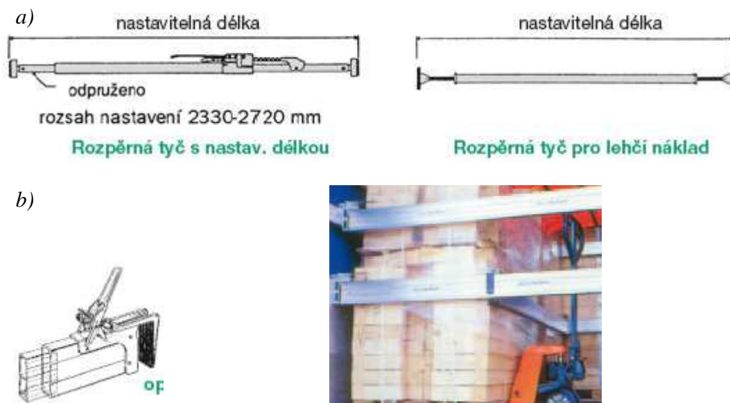
Obrázek 30 – Rozpěrné tyče (obrázek a), zábrany (obrázek b) [11]
