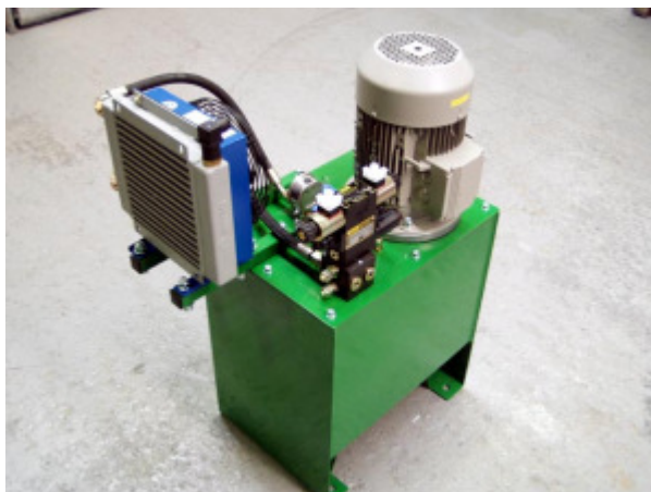
Obrázek 46 – Stacionární hydraulický agregát [15]
