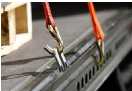
Obrázek 21 – Variabilní kotevní systém Vario fix používající firma Kögel [8]
