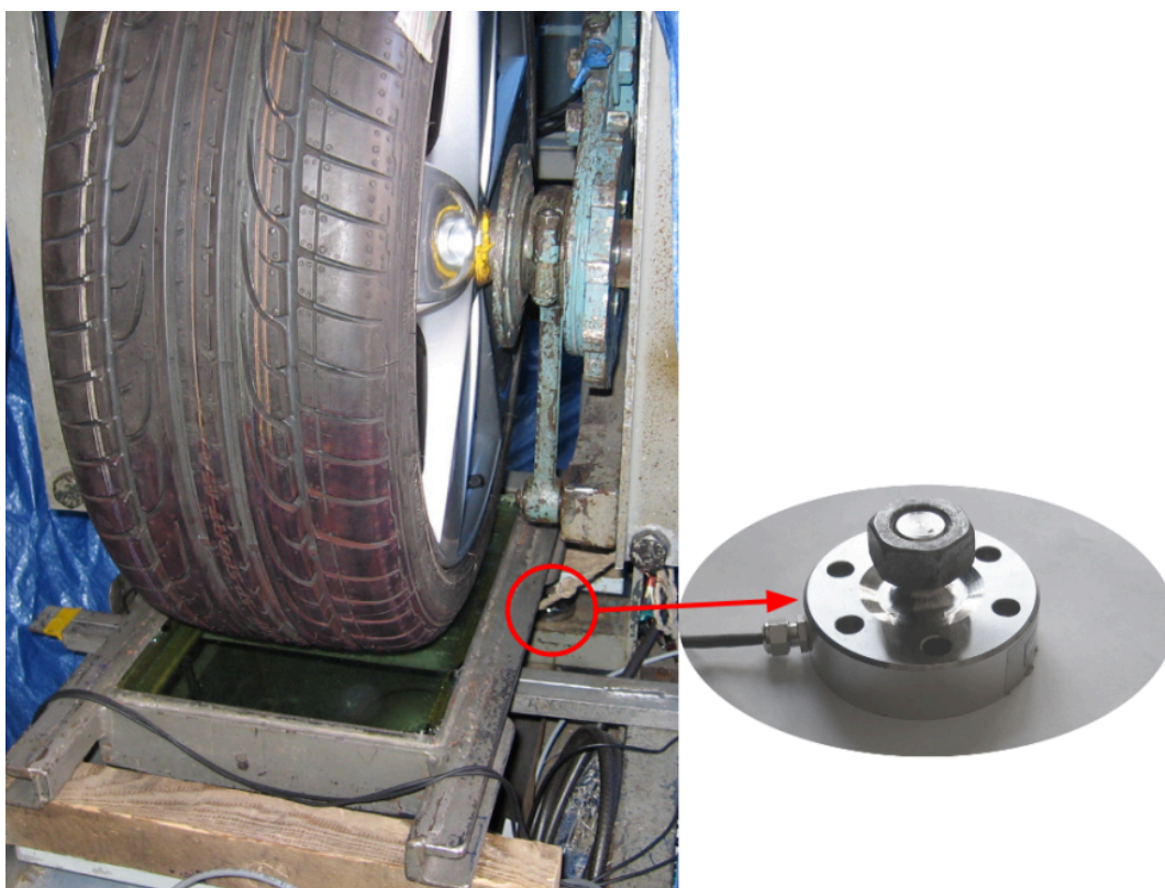
Obr. 24 – Snímač síly a jeho umístění na statickém adhezoru
