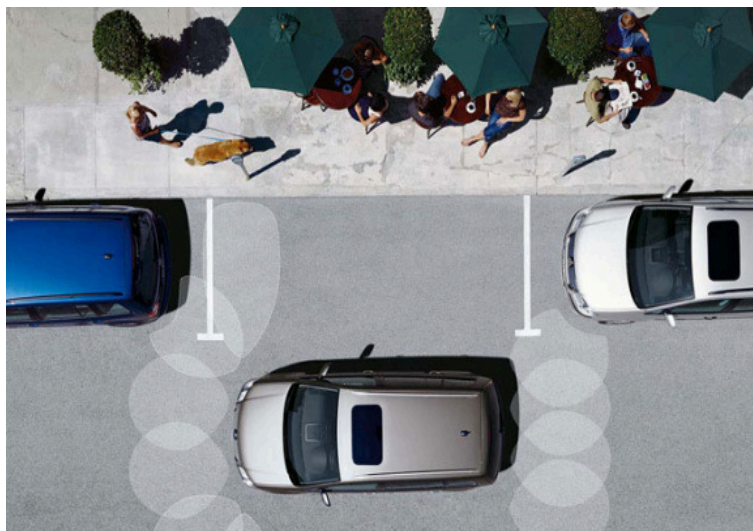
Obrázek č. 14: Vyhodnocení situace o místě pro zaparkování parkovacím asistentem
