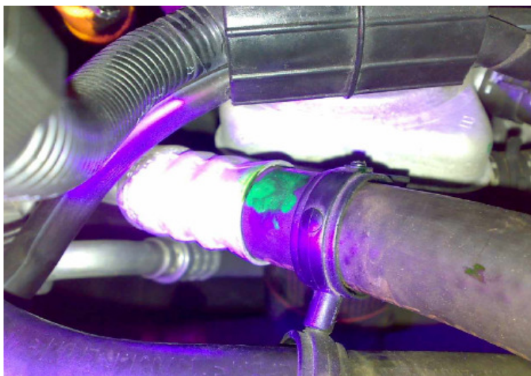
Obrázek č. 61: Zviditelnění netěsnosti pomocí UV(ultrafialové) lampy
