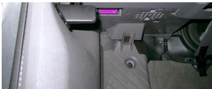
Obrázek č. 45: Diagnostická zásuvka v prostoru řidiče
