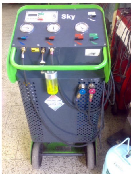
Obrázek č. 49: Servisní a plnicí přístroj pro klimatizace SKY ISC
