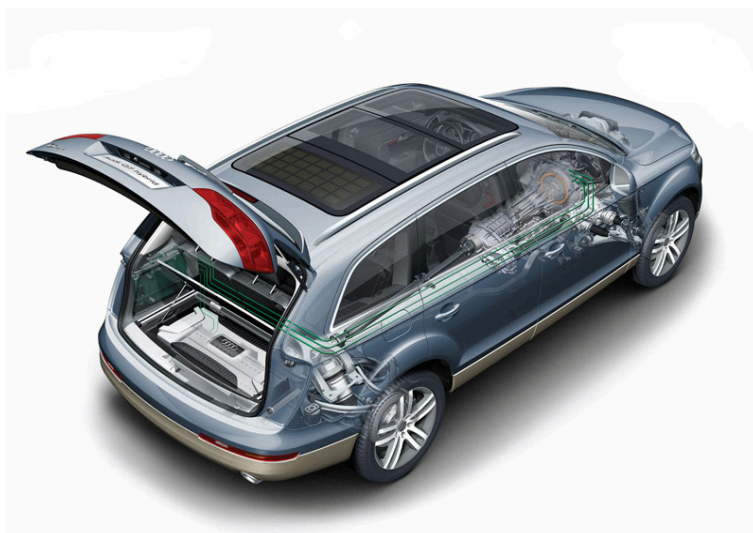
Obrázek č. 43: Pohled na solární panely střešního okna automobilu Audi
