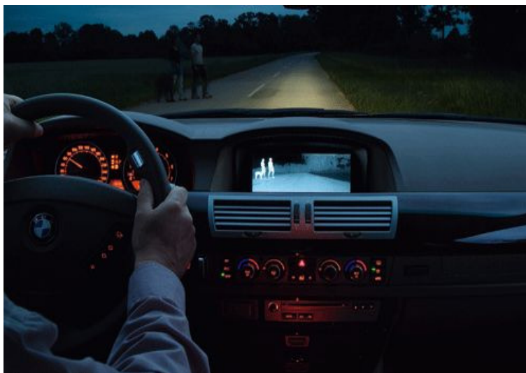
Obrázek č. 9: System pro noční vidění automobilky BMW
