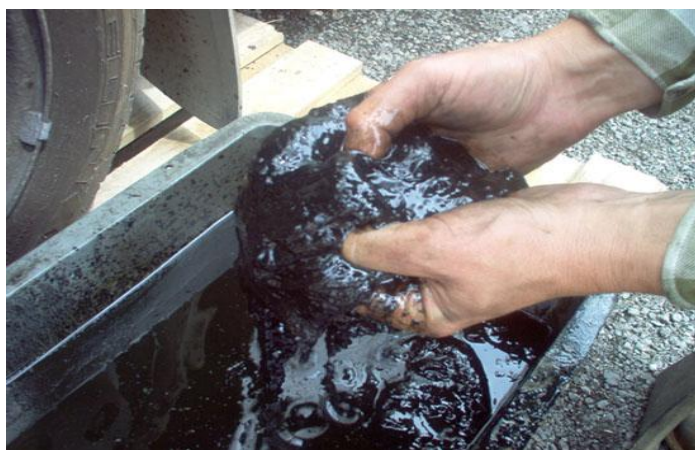
Obrázek č. 13: Glykol v motorovém oleji [24]
