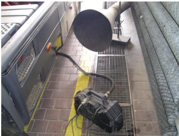
Obr. 16 Instalace opacimetru na vozidlo
