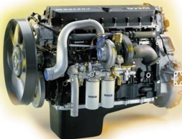
Obr. 11 Motor Cursor 10 pro nejtěžší vozidla Iveco Stralis [12]
