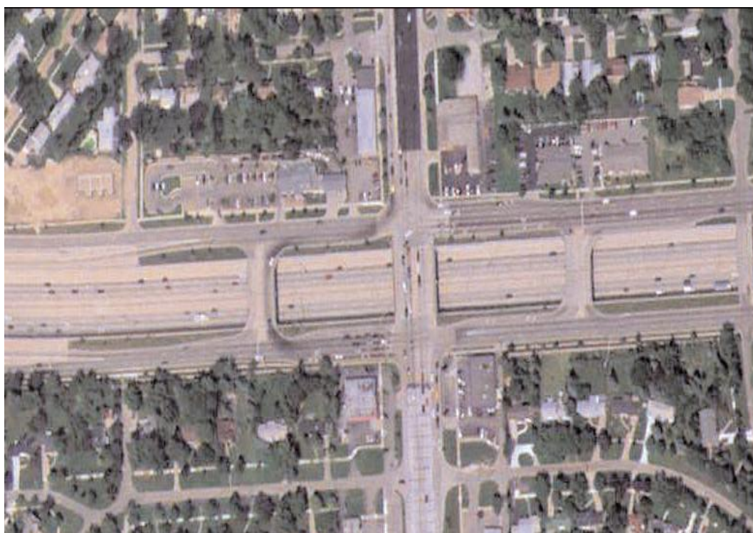
Obr.477 USA – Mimoúrovňová křižovatka kosodélná v patře úrovněvé řešení [Zdroj obrázeček poskytnutý k užití pro DP]
