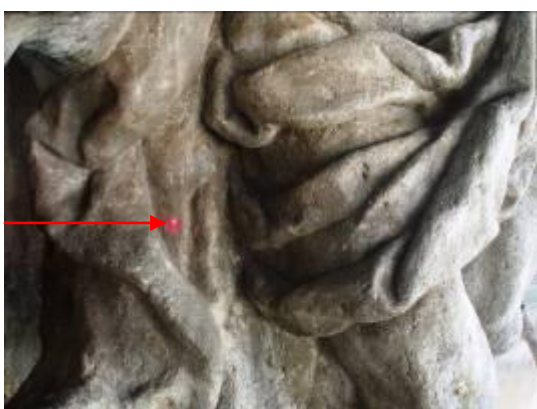
Obr. 111. Vzorek č. 9–4 – sv. Šebestián – drapérie – nebyl připraven příčný řez a sled vrstev je: tmavošedá, růžová, světleokrová, bílá – ve všech olovnatá běloba. Bez zlomku kamene nelze jednoznačně určit lokalizaci jednotlivých vrstev.
