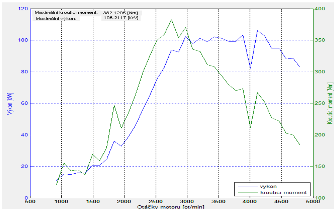
Obrázek 31 - VW Passat 1.9 TDI, Průběh výkonu a točivého motoru pomocí měření celkového zrychlení vozidla
