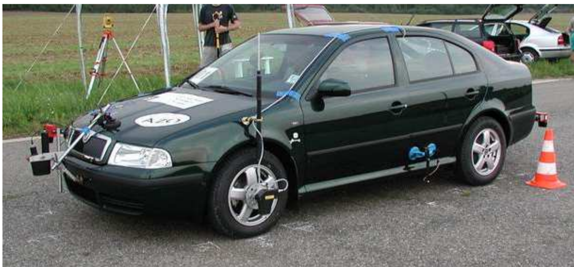
Obrázek 3 - Příklad měření rychlosti pomocí otáček kola.
