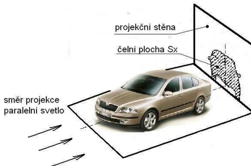
Obrázek 6 - Zjištění čelní plochy vozidla - tzv. projekce čelní plochy[2]
