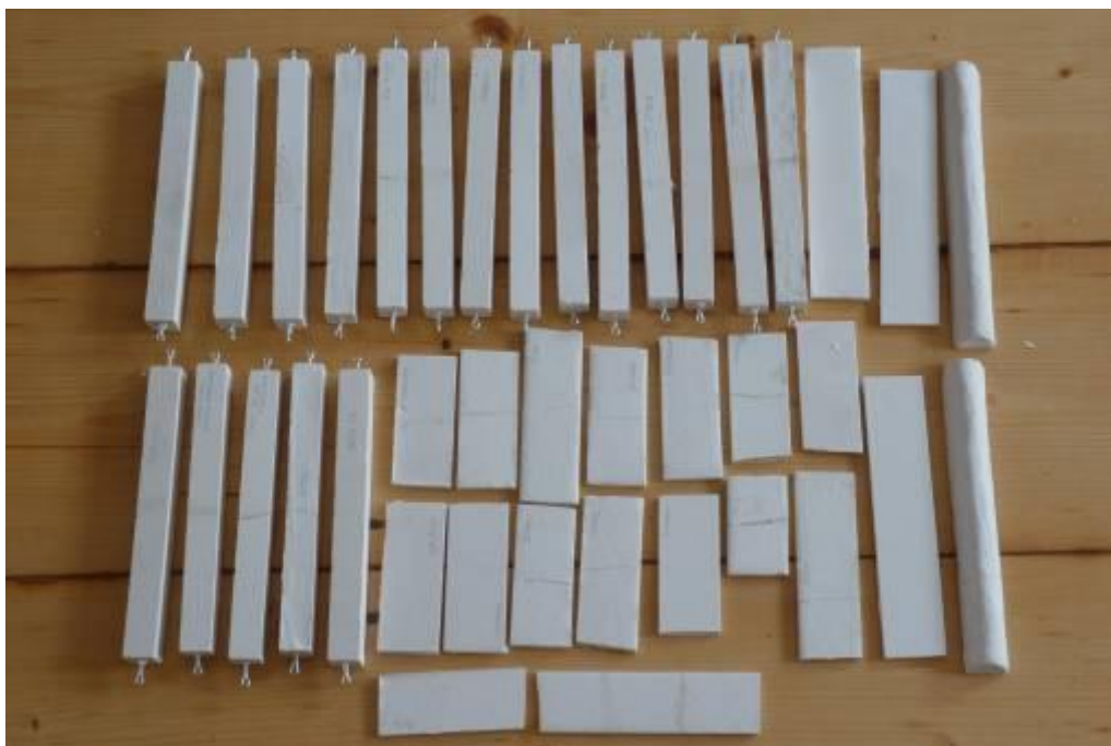
Obr. 26 stav po slepení sádrových tělísek, před zkouškou pevnosti lepeného spoje v tahu
