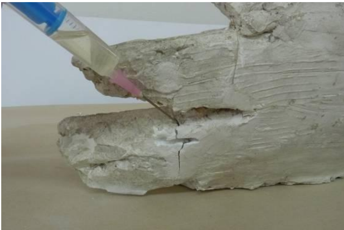
Obr. 29 průběh restaurování – lepení praskliny vyztužené jutou
