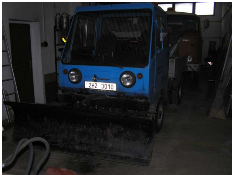
Obrázek č. 9 – Multicar M25 s rozmetadlem písku a čelním pluhem Zdroj: autor
