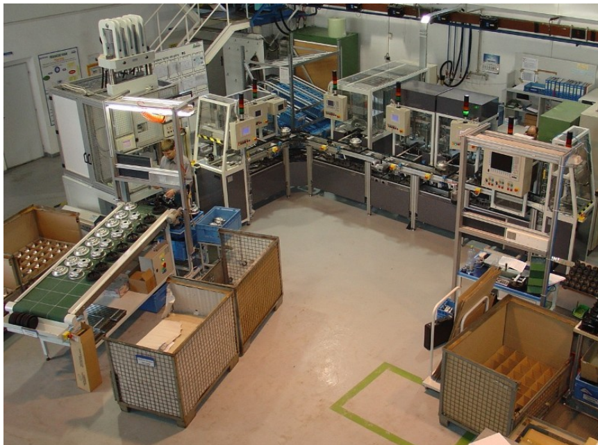
Obrázek č. 1 - Automatická montážní a testovací linka na brzdové válce nákladních automobilů
