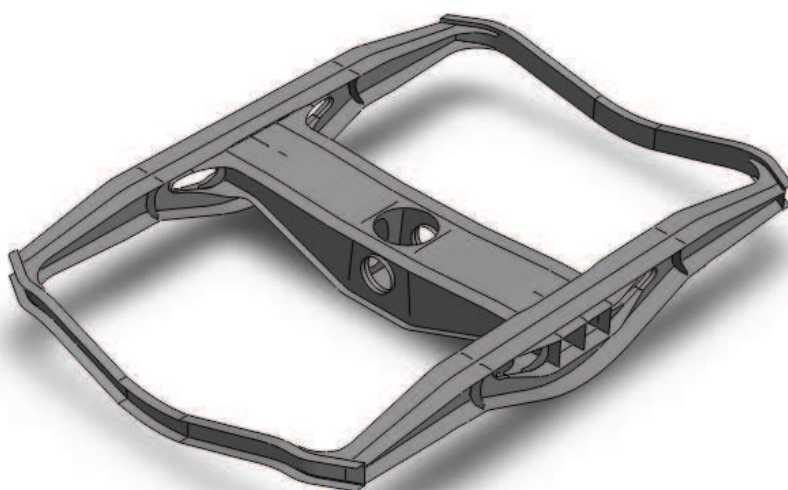
Obr. 4: Trojrozměrný model rámu podvozku s nosiči brzdy
