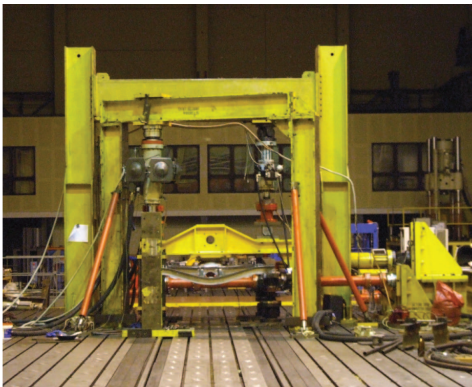
Obr. 1: Rám podvozku Y25 ve zkušebním zařízení VUZ v Cerhencích. [21]
