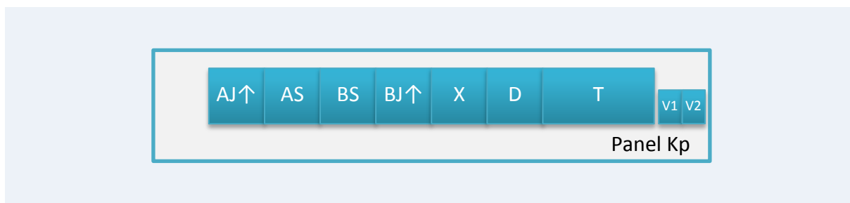
Obr. 2.5 Osazení relé panelu Kp2 – čelní pohled
