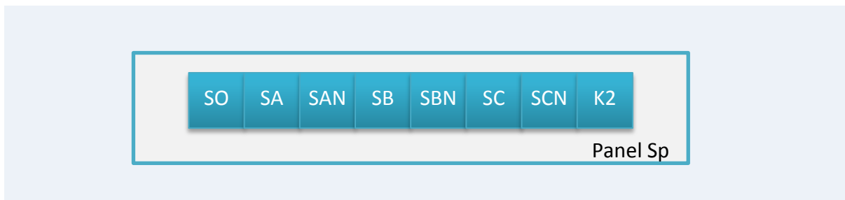
Obr. 2.7 Osazení relé panelu Sp2 – čelní pohled
