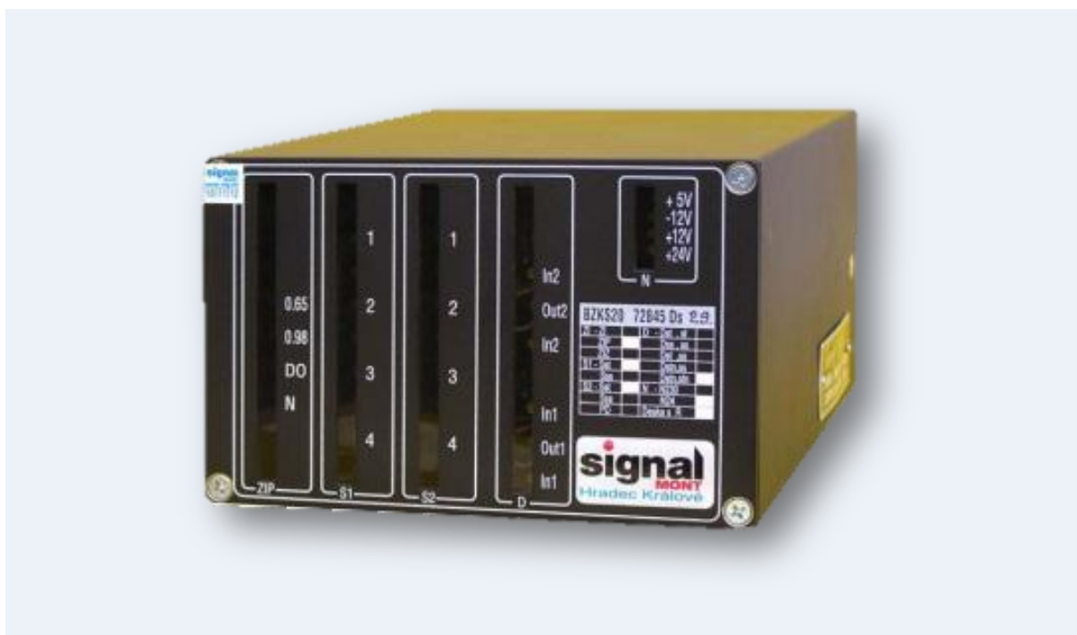
Obr. 2.22 Bezkontaktní zdroj kmitavých signálů BZKS20
