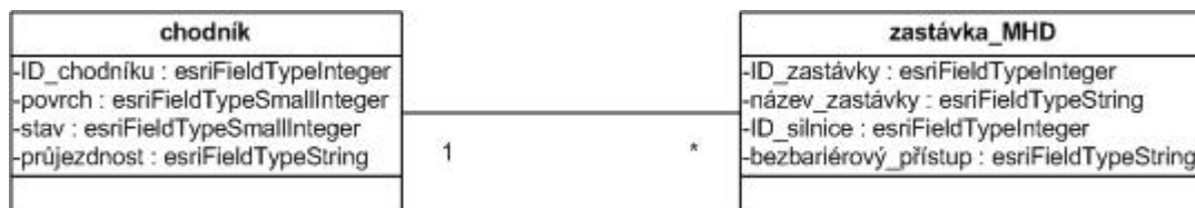
Obr. 2: Vztah tříd typu jedna k více, notace UML
