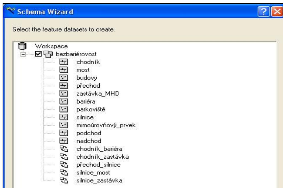
Obr. 5: Načtení schéma geodatabáze ze souboru XML
