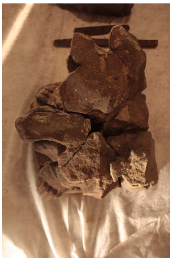
Foto č. 60. statická porucha v důsledku růstu náletů, Prosečné – boží muka při čp. 30 Foto č. 61. radiální rozpuknutí sochy v důsledku koroze čepu, Vysoké n. Jizerou - sloup se sv. Antonínem
