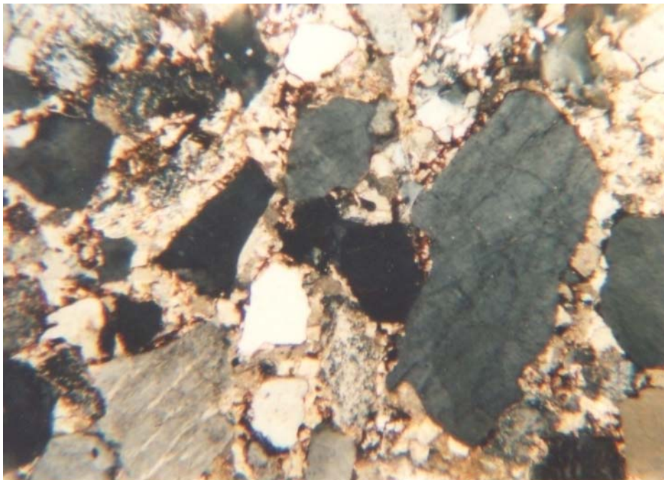
Pískovec arkózovitý středně zrnitý vzorek ÚP - 1, zvětšeno 32x, nikoly X
