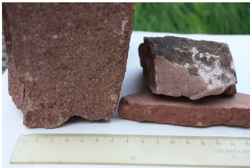
Foto 22. struktura a textura úpického pískovce
