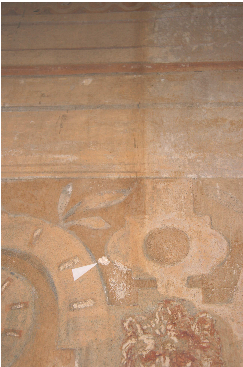
Obr. č. 24 Snímek ukazuje průběh snímání staré fixáže a přemalob z povrchu originální barevné vrstvy
