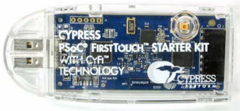
Obr. 13 Programátor s možností I2C komunikace
