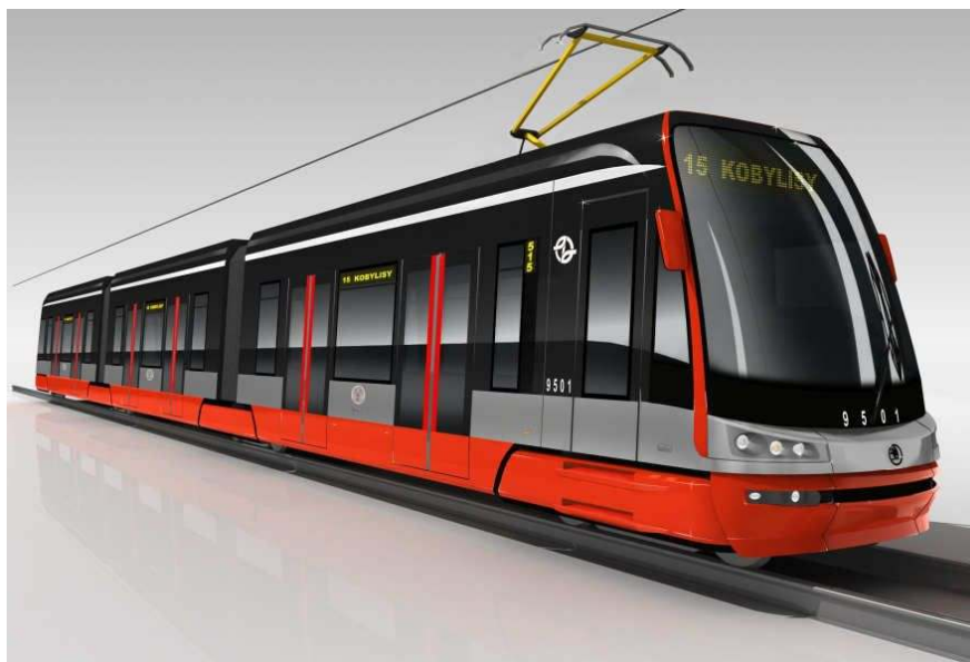
Obr. 5 Tramvaj Škoda 15T ForCity s přímým pohonem kol pomocí plně odpružených PMSM
