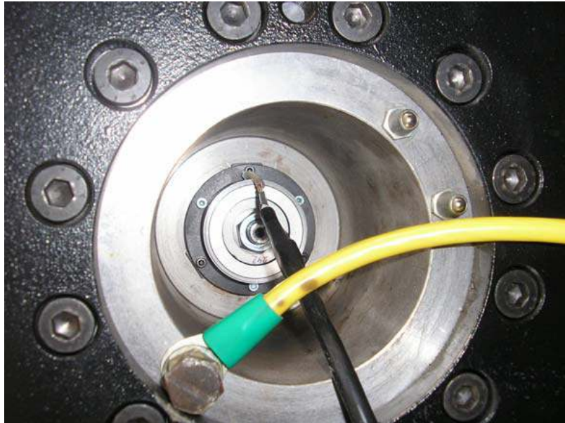
Obr. 24 Detail uchycení resolveru v PMSM
