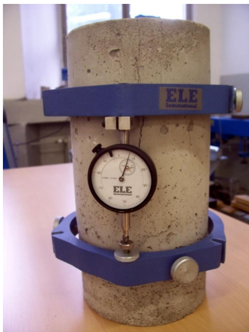
Obr. 31 – osazovací zařízení a hodinkový deformometr pro stanovení modulu pružnosti
