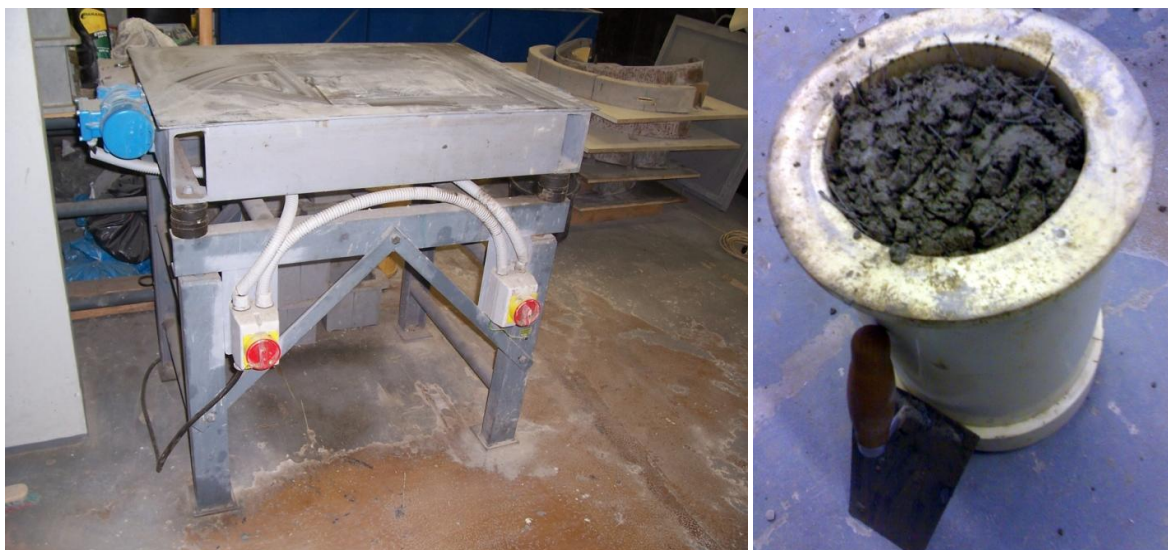
Obr. 14 – vibrační stůl a drátkobetonem naplněná forma na válečky
