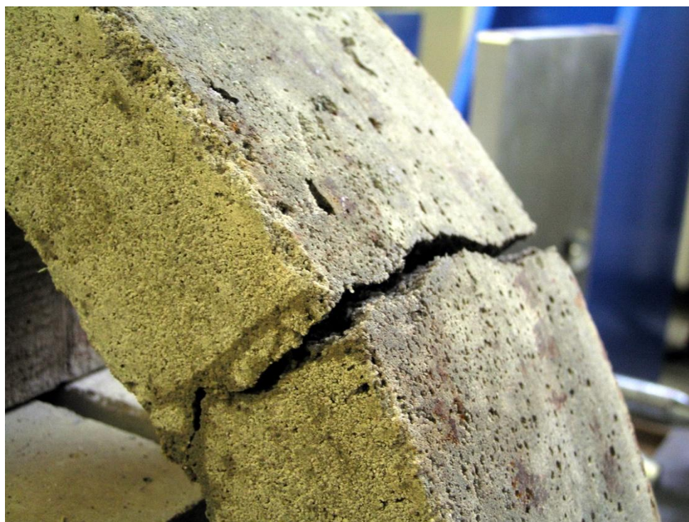
Obr. 52 – detail porušení klenby z prostého betonu
