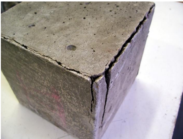
Obr. 26 – Zkušební těleso z prostého betonu, po ukončení zkoušky pevnosti v tlaku
