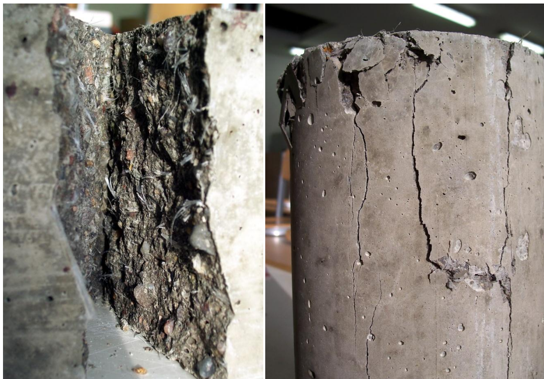
Obr. 41 – tělesa po provedení zkoušek (vlevo trámek, vpravo válec)
