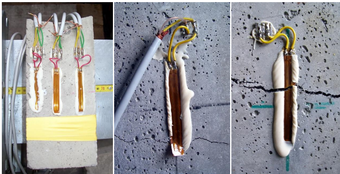
Obr. 66 – Tenzometry (vyrovnávací můstek; deformace tenzometrů)
