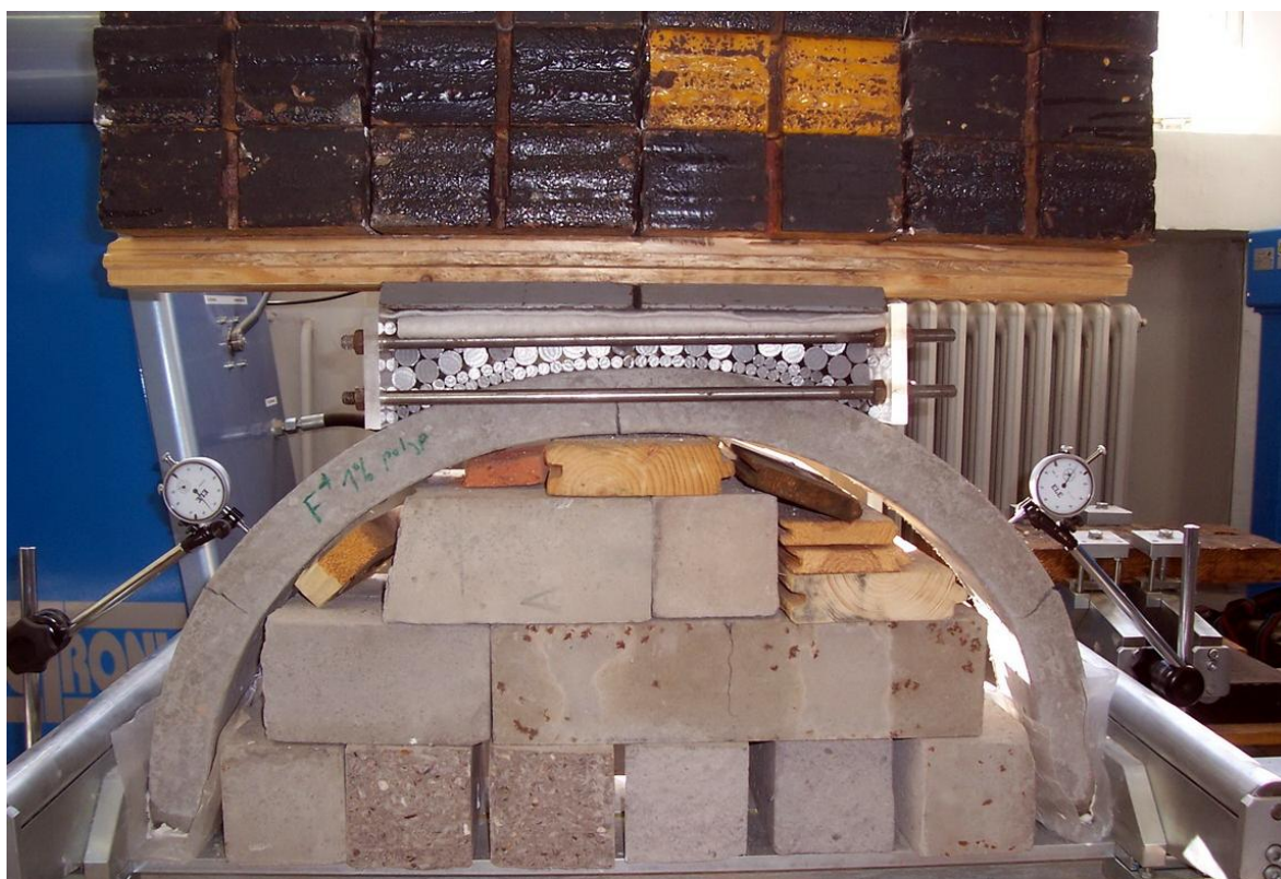
Obr. 58 – Zatěžování klenby ze směsi IPOLnen s viditelným způsobem zajištění podpor, osazení deformometry a prokreslenými trhlinami
