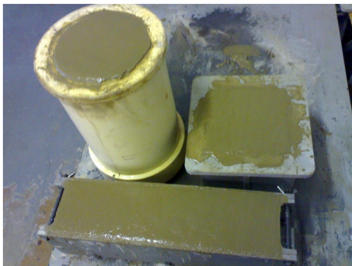
Obr. 13 – naplněné formy pro výrobu zkušebních těles (válec, krychle, trámek)
