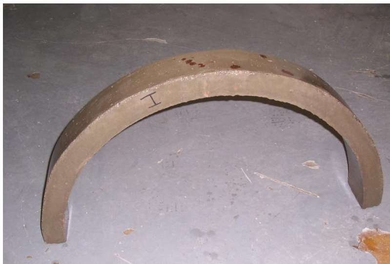
Obr. 22 – zkušební těleso – klenba
