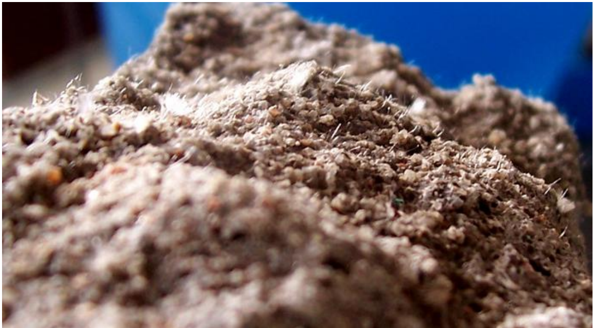
Obr. 56 – detailní pohled na deformační plochu klenby ze směsi IPOLnor s viditelnými PP vlákny
