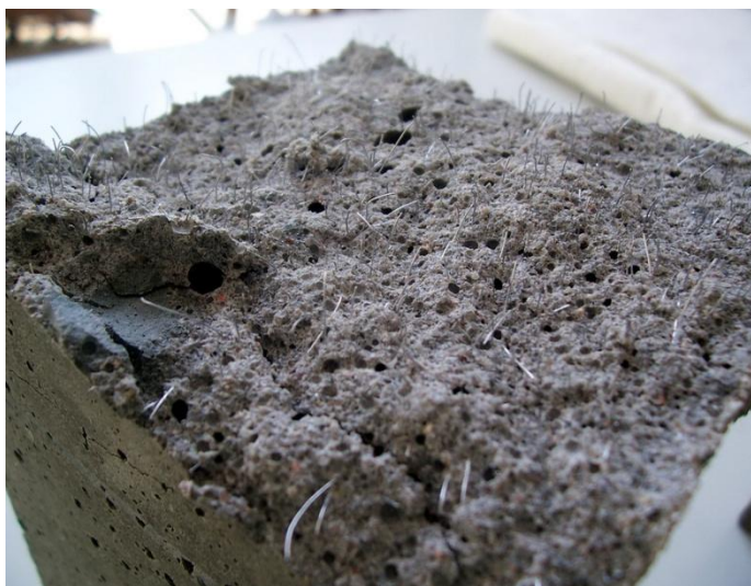
Obr. 45 – Pohled na deformační plochu trámku z betonové směsi 1 % drátek
