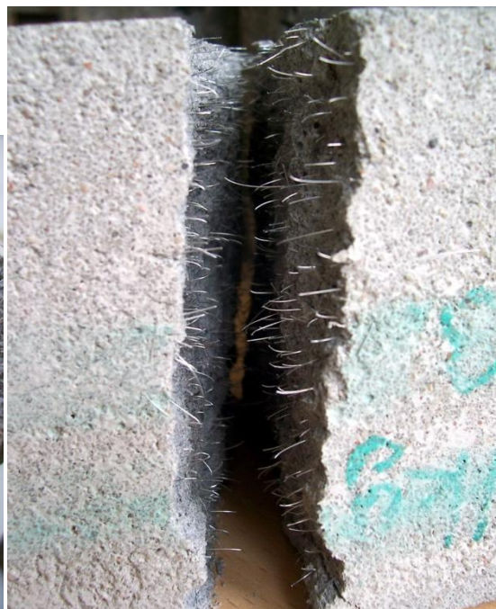
Obr. 45 – Pohled na deformační plochu trámku z betonové směsi 1 % drátek
