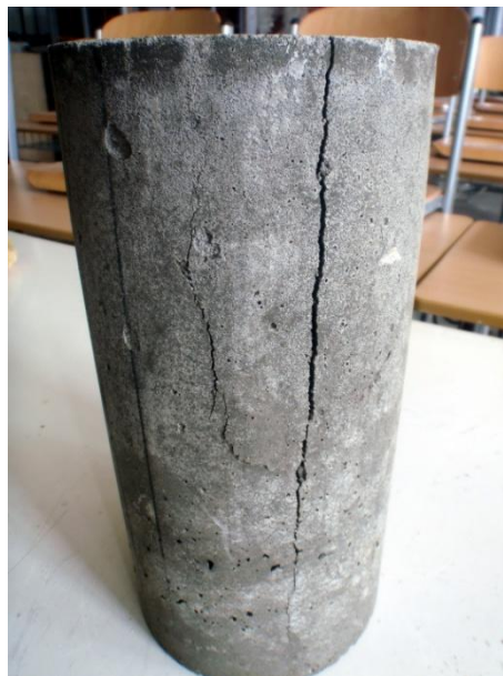
Obr. 43 – Válec ze směsi JPnor po tlakové zkoušce
