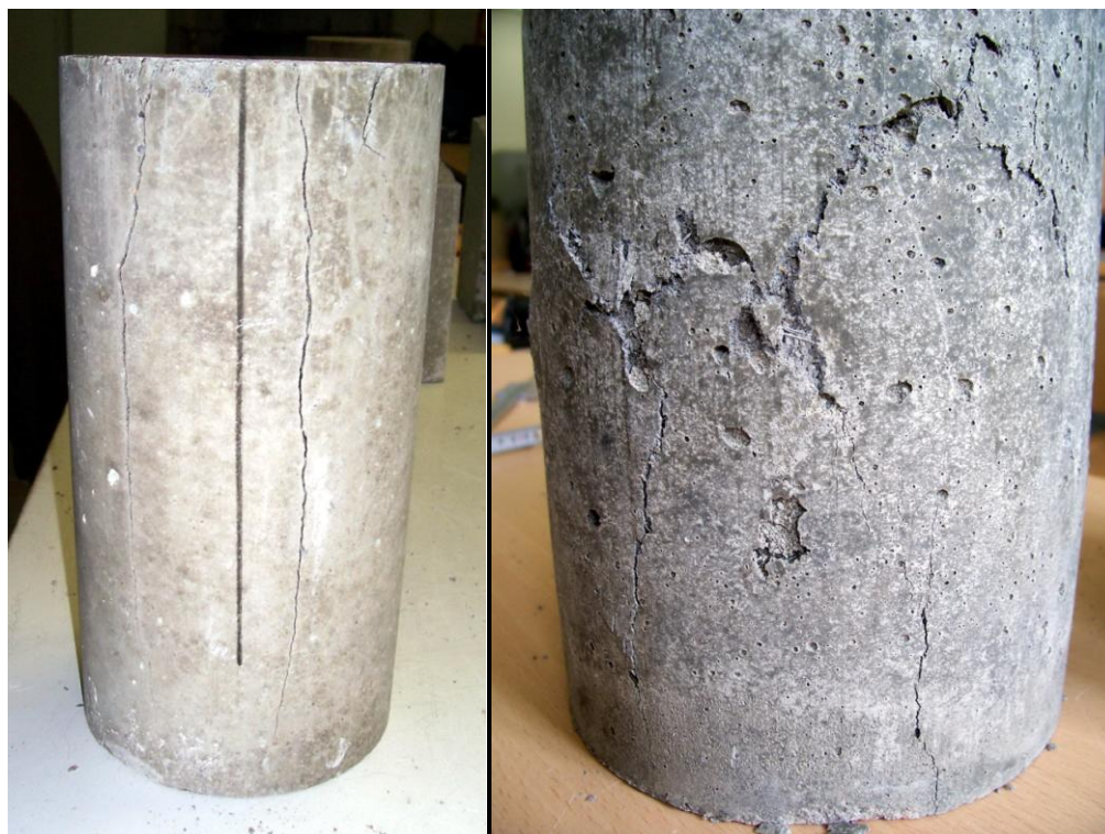
Obr. 33 – porušená tělesa po skončení zkoušky ke stanovení modulu pružnosti (klasická směs, prostý beton vlevo; poměrová směs 1% drátek vpravo)
