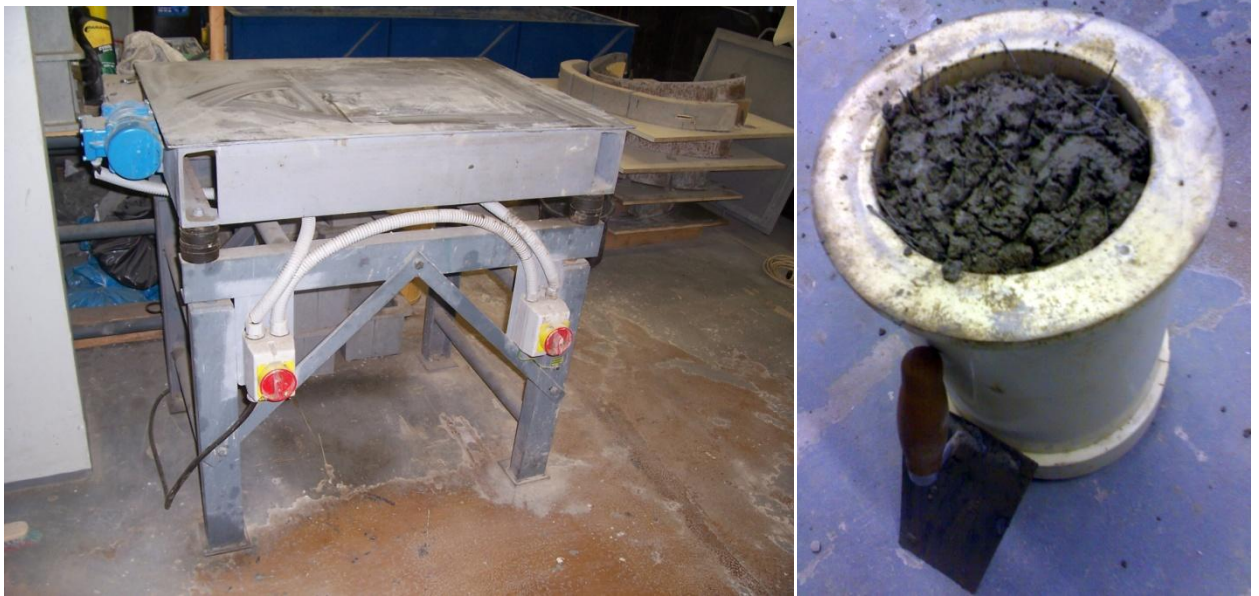
Obr. 23 – vibrační stůl a drátkobetonem naplněná forma na válečky
