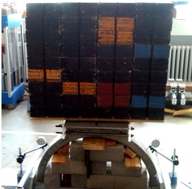
Obr. 63 - Klenba bez zjevných porušení odolává zatížení 24 kN/m (směs 1% drátek)
