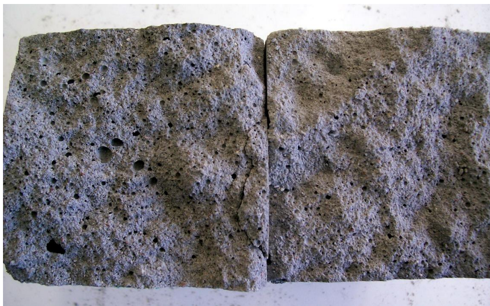
Obr. 44 – porovnání deformačních ploch trámeček (vlevo JPnenor , vpravo IPOLnen )
