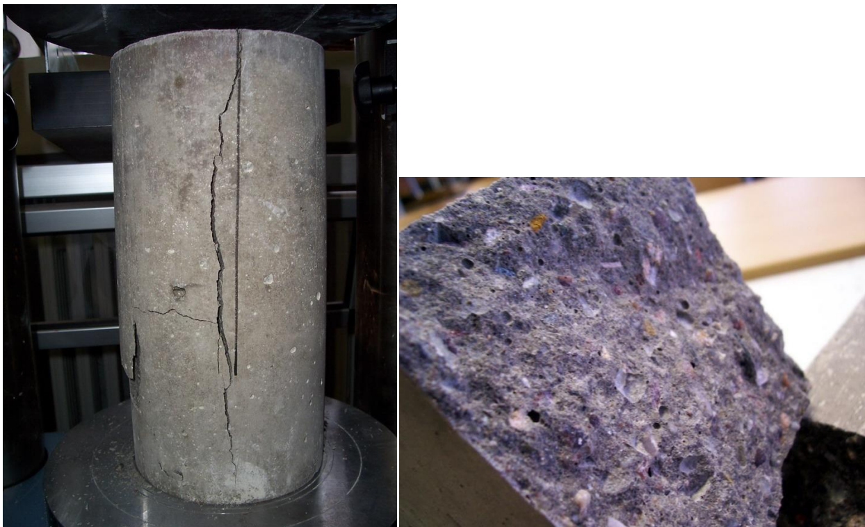
Obr. 40 – válec po ukončení zkoušky v prostém tlaku a detail lomové plochy trámečku
