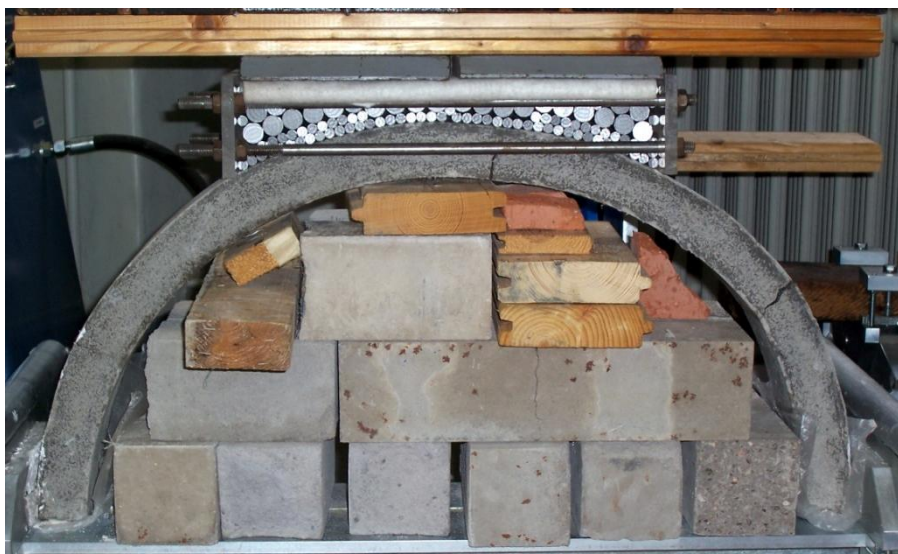
Obr. 60 – Porušení klenby ze směsi 3POL s viditelnou trhlinou v pravé části a ve vrcholu
