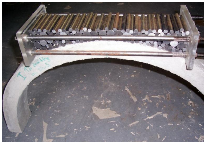
Obr. 34 – záchytné zařízení naplněné válečky simulujícími přenos spojitého zatížení
