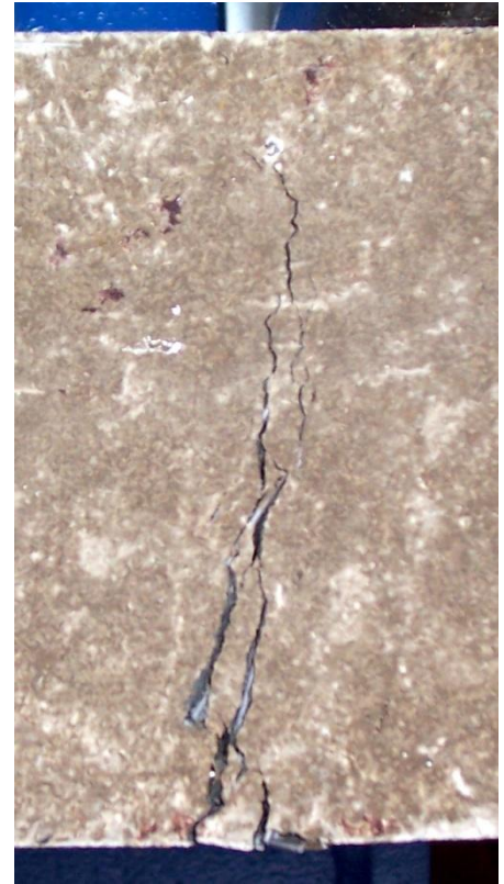
Obr. 30 – DB vzorek po ukončení zkoušky pevnosti v tahu za ohybu
