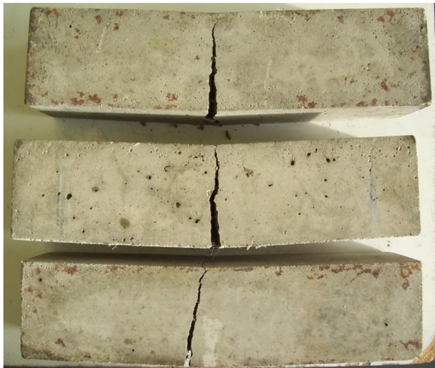
Obr. 29 – vzorky porušené tahem za ohybu (klasická směs vyztužená PP vlákny)
