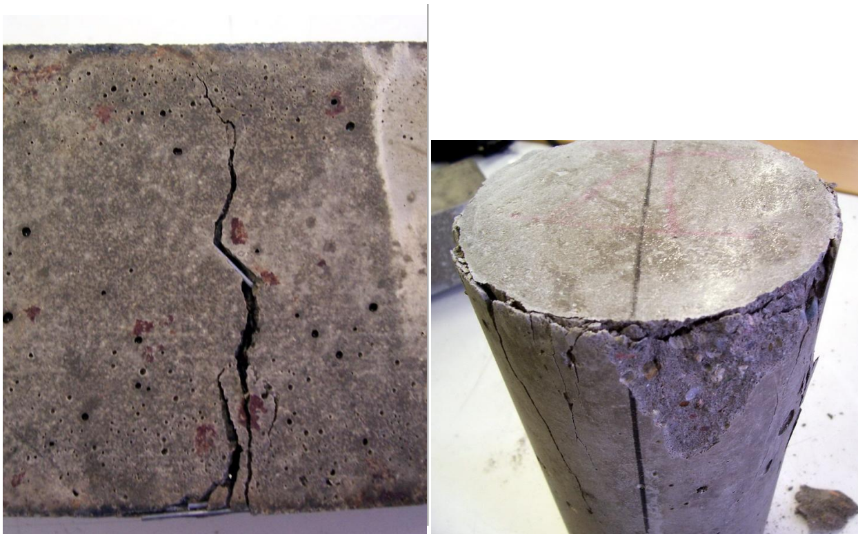
Obr. 42 – deformovaná zkušební tělesa vyztužená drátky (vlevo trámek, vpravo válec)
