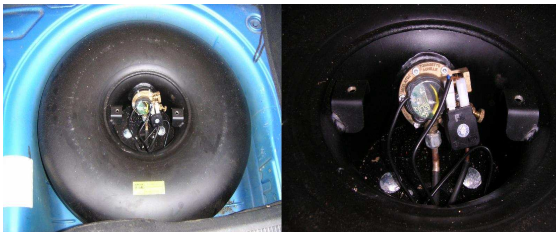
obrázek 5 – Toroidní tlaková nádrž a detail multiventilu
