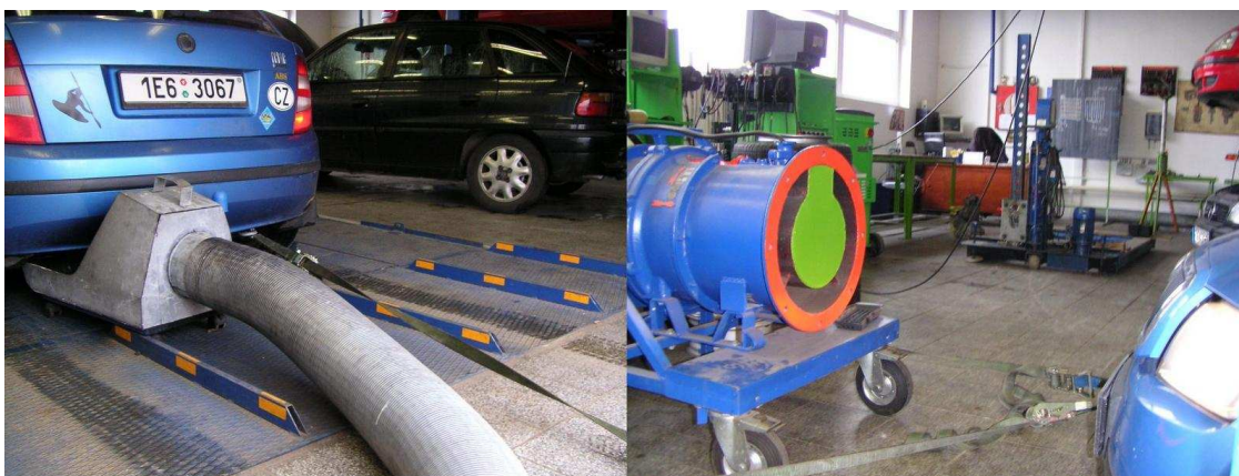
obrázek 13 - Odsávací zařízení a ventilátor
