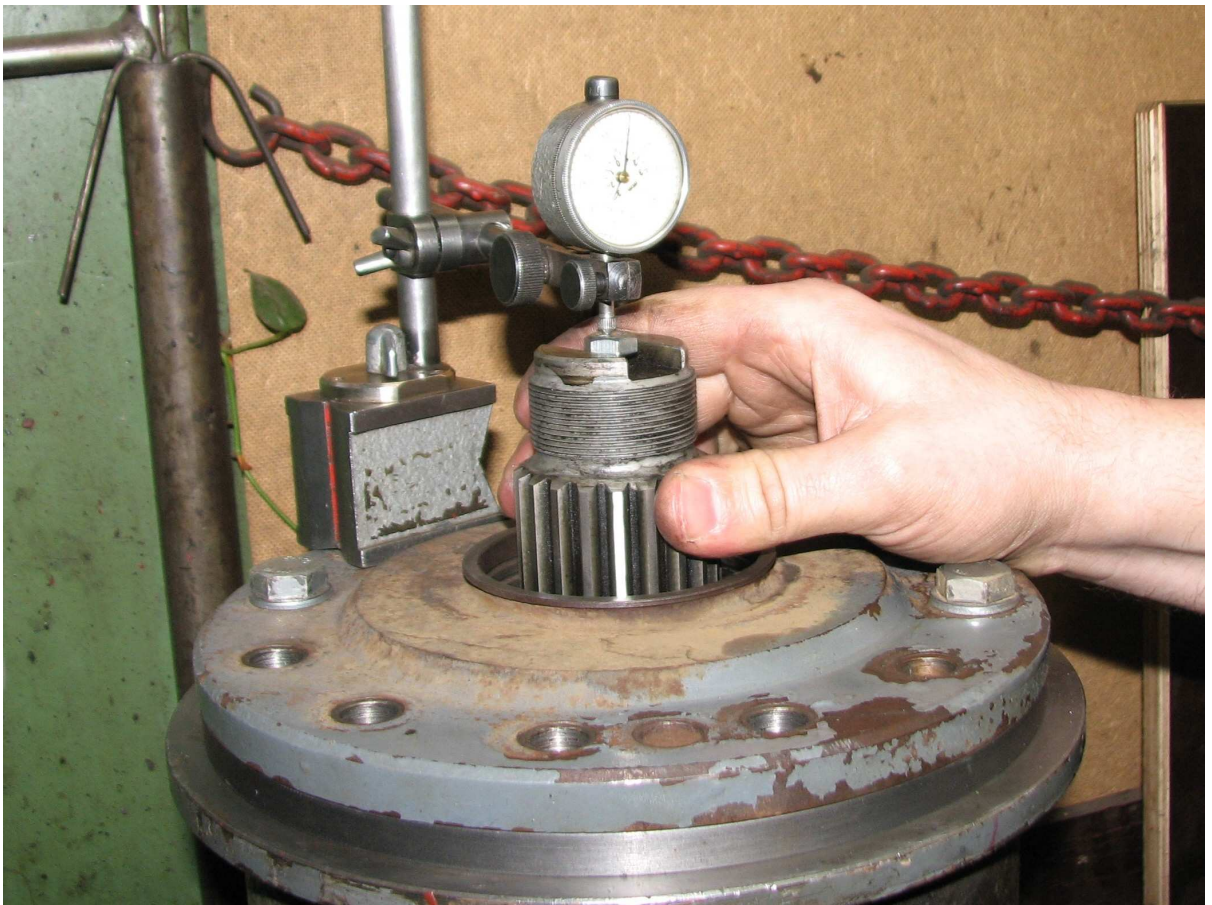
Obr. 15 Měření axiálních vůlí pastorku hloubkoměrem
