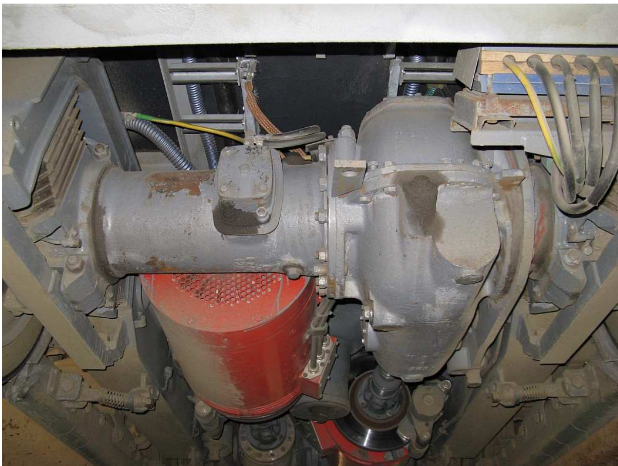
Obr. 4 Vedení dvojkolí Meggi prvky u vozu Vario LF (1554) [foto: Martin Hemzal]
