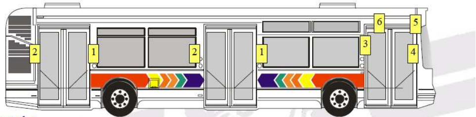
Obr. 29 Rozmístění zařízení v dopravním prostředku v MHD
