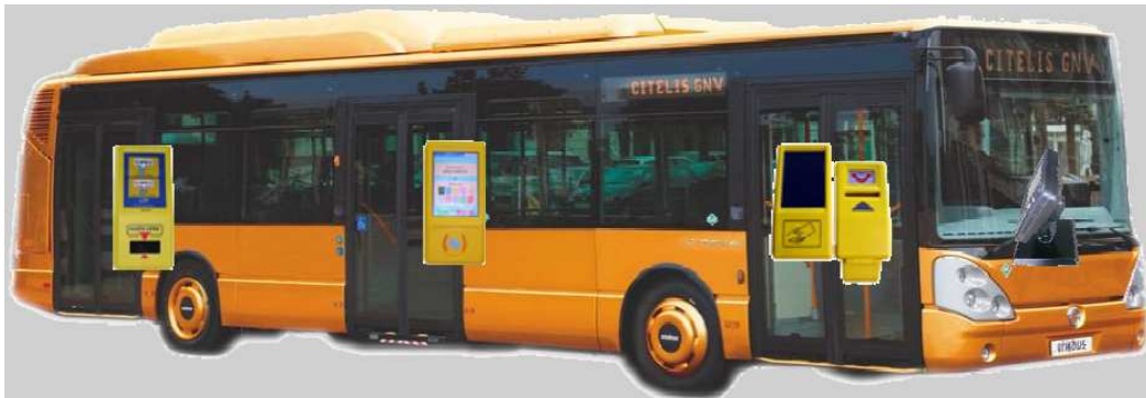
Obr. 30 Rozmístění zařízení v dopravním prostředku MHD 2
