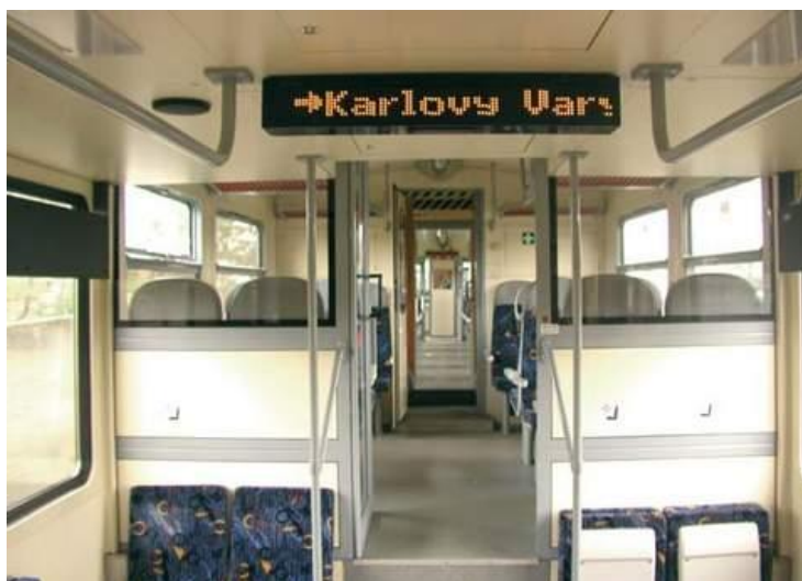
Obrázek 23 Motorová jednotka vybavená informačním systémem InfoTrain
