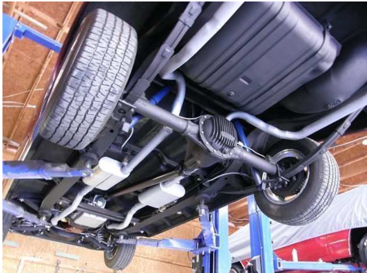
Obr. 8 – Tuhá hnací náprava vedená listovými perami na vozidle Chevrolet [6]
