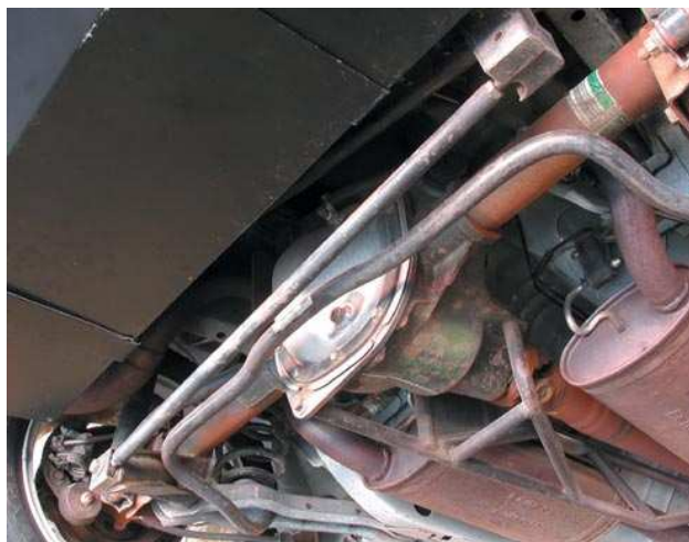
Obr. 13 – Panhardská tyč na vozidle Ford Mustang 2000 [4]
