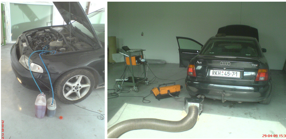
Obr. 28 a 29 Měření emisí v STK Jilemnice [foto autor]
