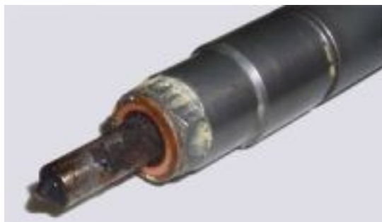
Obr. 30 Zakarbonovaný vstřikovač [foto autor]
