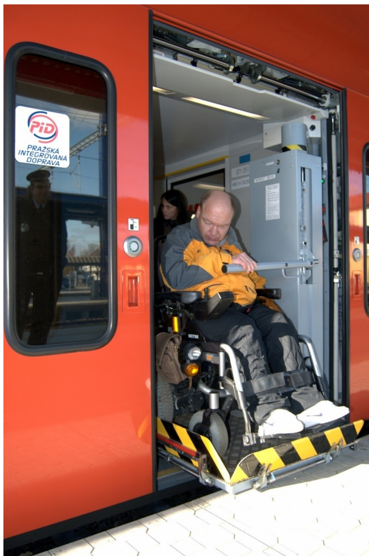
Obrázek 5: Užití zdvižné plošiny v jednotce ČD řady 471
