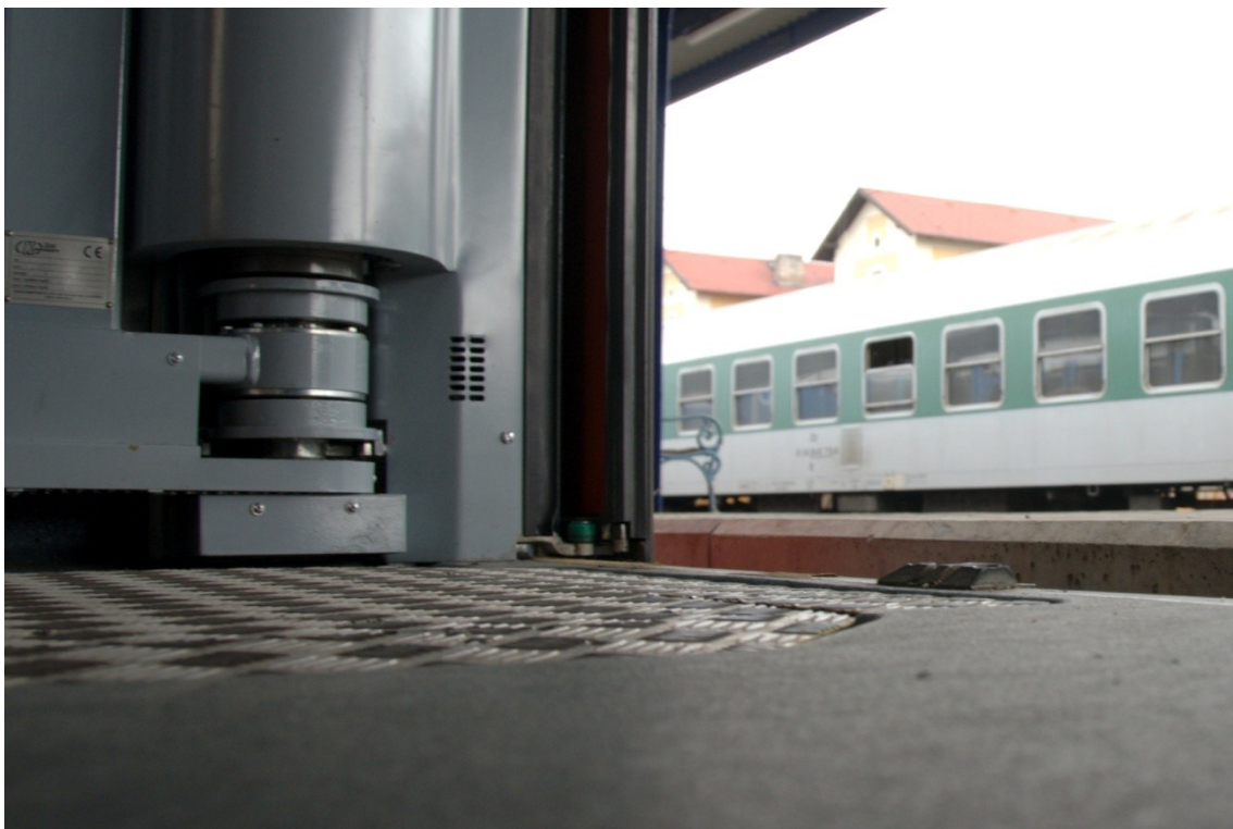
Obrázek 11: Vertikální rozdíl mezi výstupním prostorem jednotky 471 a 2. nástupištěm v ŽST Benešov u Prahy
